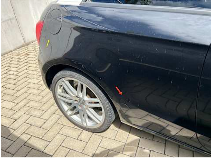
Seitenteil hinten rechts (Kratzer, Verformung, Delle)
