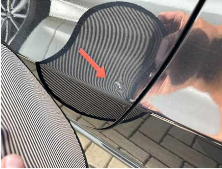
Fahrtür (Kratzer, Verformung)
