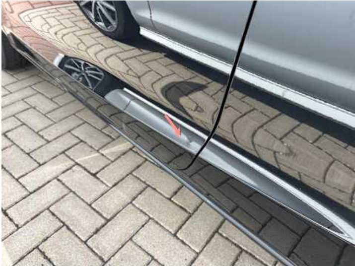
Fahrtür (Kratzer, Verformung)
