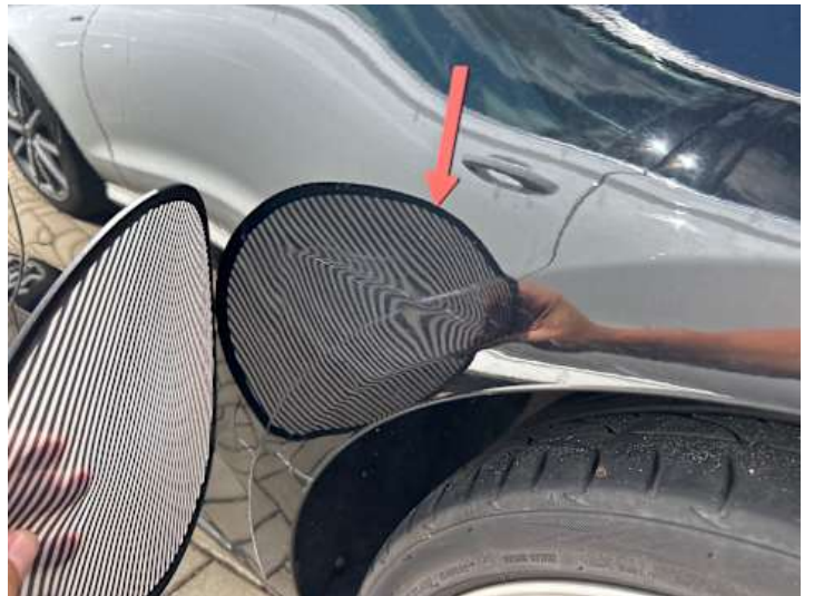
Seitenteil hinten links (Kratzer, Verformung)
