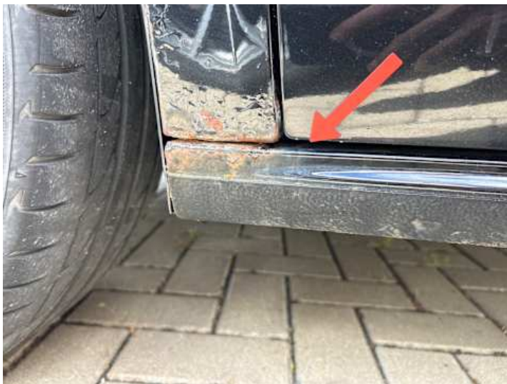
Schweller links (Rost)
