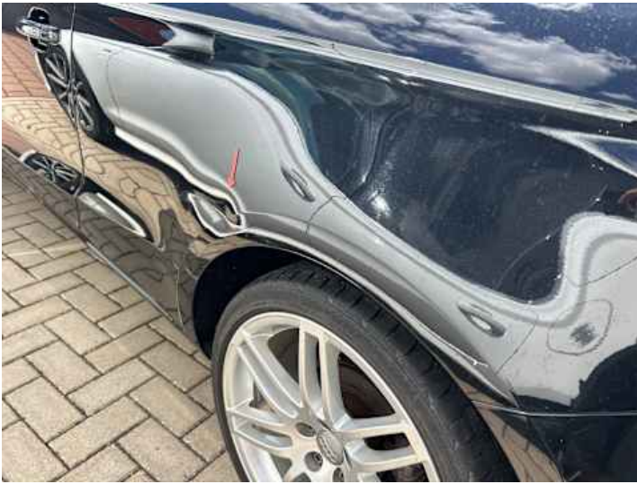
Seitenteil hinten links (Kratzer, Verformung)
