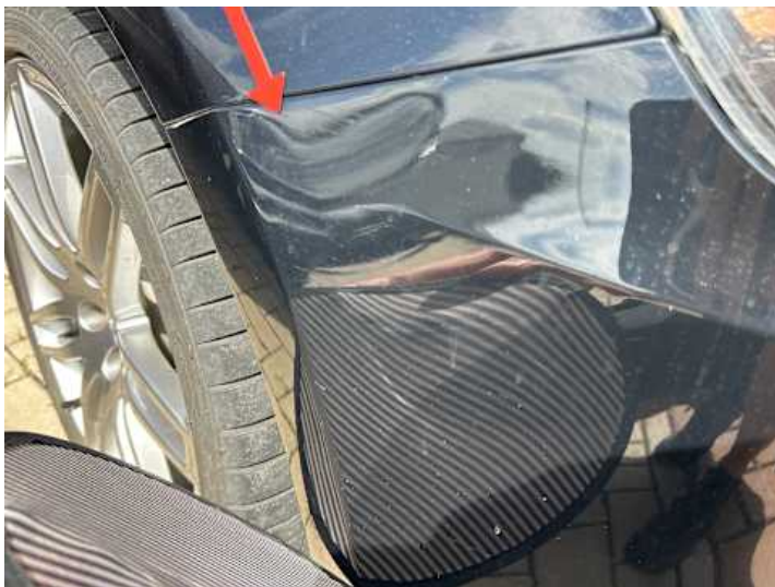
Stoßstange vorne (Kratzer, Unsachgemäß instand gesetzt)
