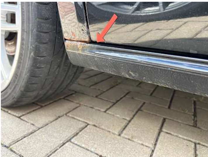
Schweller links (Rost)
