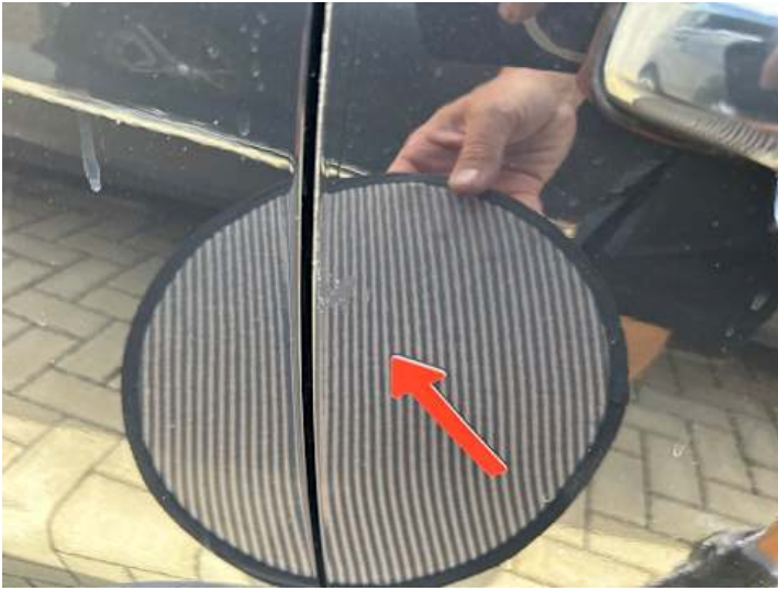
Beifahrtür (Kratzer, Unsachgemäß instand gesetzt)
