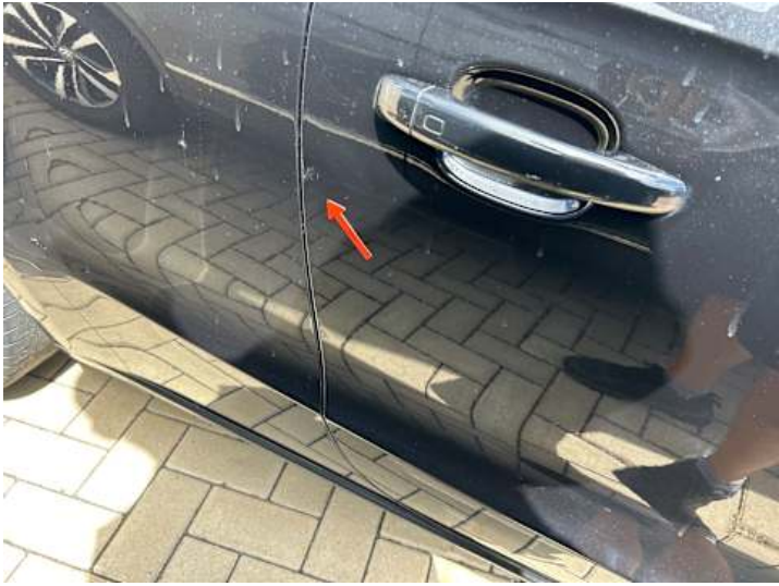
Beifahrtür (Kratzer, Unsachgemäß instand gesetzt)
