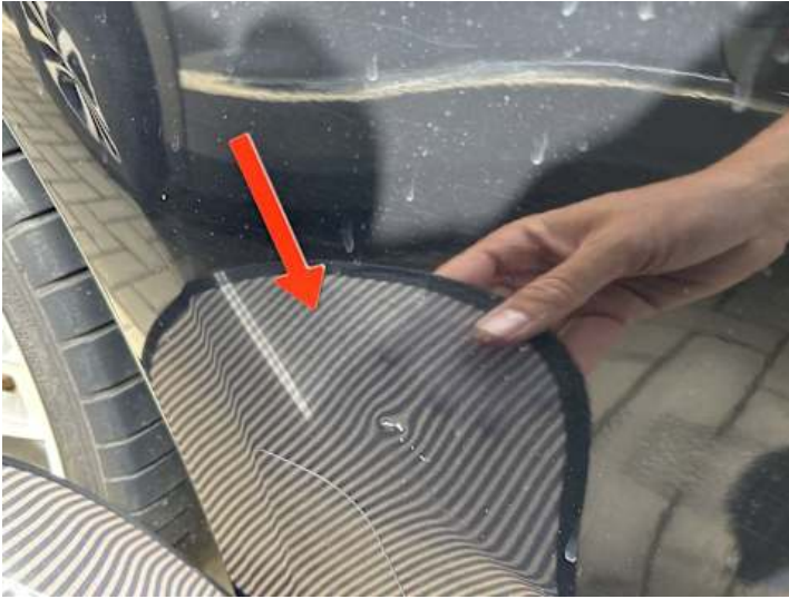
Seitenteil hinten rechts (Kratzer, Verformung, Delle)
