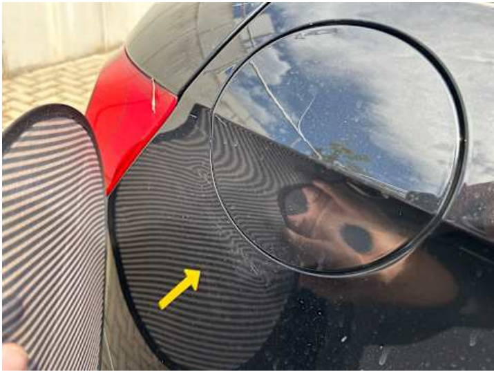
Seitenteil hinten rechts (Kratzer, Verformung, Delle)
