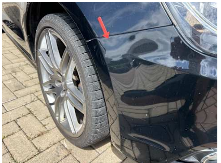
Stoßstange vorne (Kratzer, Unsachgemäß instand gesetzt)
