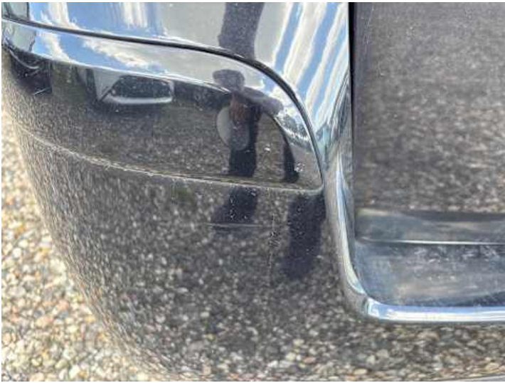
Stoßstange hinten (Lackschaden, Kratzer, Delle)
