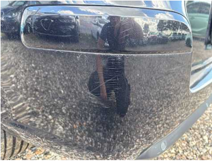
Stoßstange hinten (Lackschaden, Kratzer, Delle)
