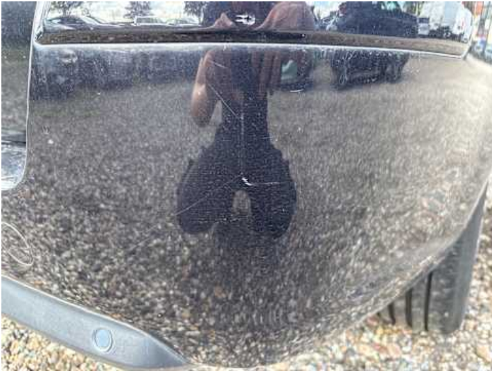
Stoßstange hinten (Lackschaden, Kratzer, Delle)
