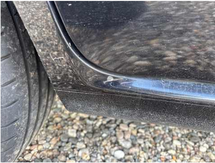
Schweller rechts (Lackschaden)
