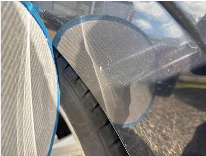
Seitenteil hinten links (Lackschaden, Delle)
