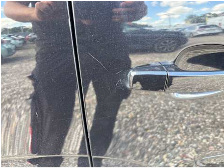
Türe hinten rechts (Kratzer, Lackschaden)
