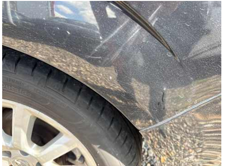
Seitenteil hinten links (Lackschaden, Delle)
