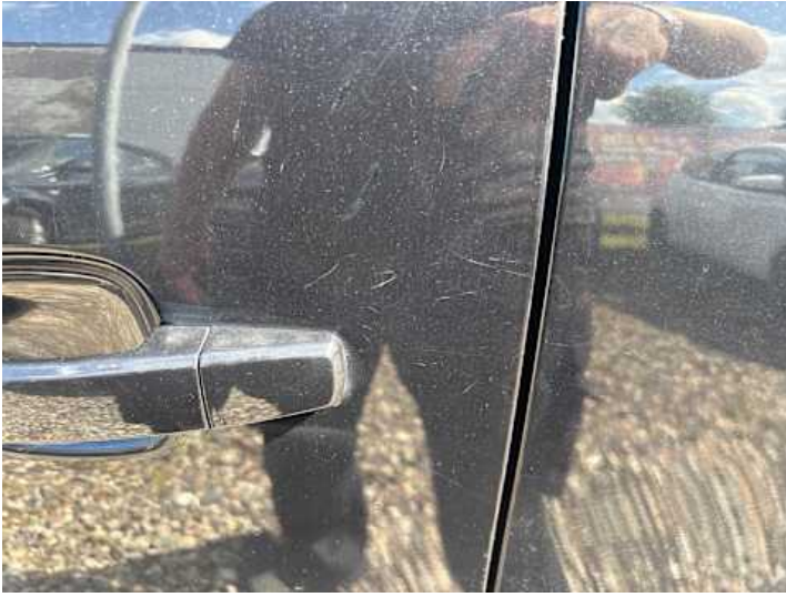
Türe hinten links (Lackschaden, Kratzer, Unsachgemäß instand gesetzt)
