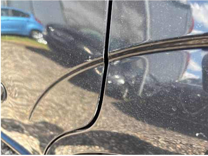
Türe hinten links (Lackschaden, Kratzer, Unsachgemäß instand gesetzt)
