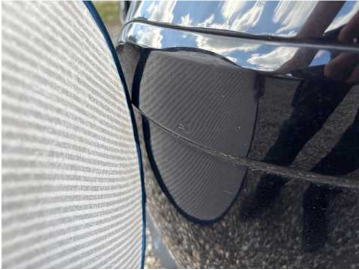
Stoßstange hinten (Lackschaden, Kratzer, Delle)
