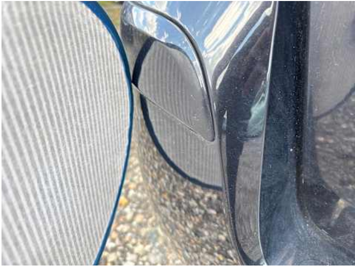
Stoßstange hinten (Lackschaden, Kratzer, Delle)
