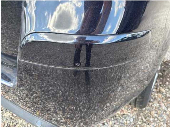
Stoßstange hinten (Lackschaden, Kratzer, Delle)
