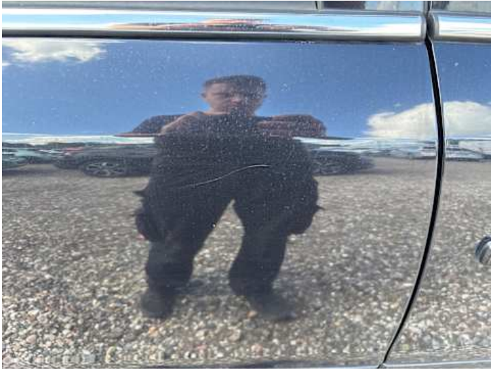
Türe hinten rechts (Kratzer, Lackschaden)
