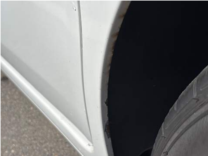
Seitenteil hinten links (Kratzer, Lackschaden, Rost)
