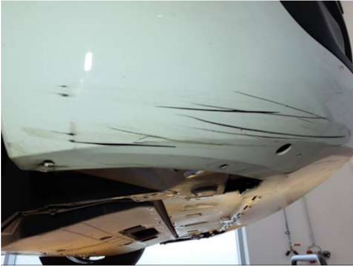
Stoßstange vorne (Lackschaden, Kratzer)
