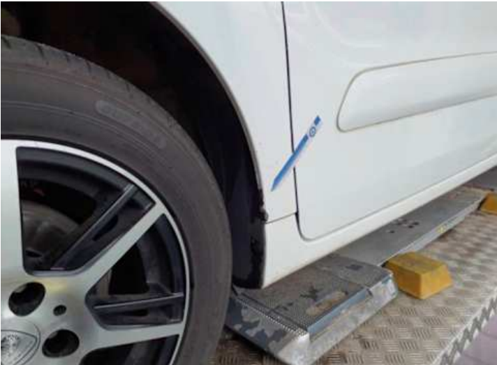
Seitenteil hinten rechts (Lackschaden, Rost, Kratzer)
