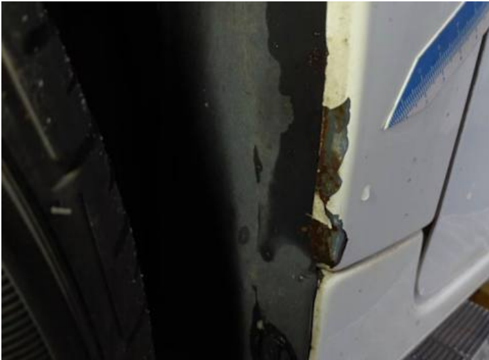
Seitenteil hinten rechts (Lackschaden, Rost, Kratzer)
