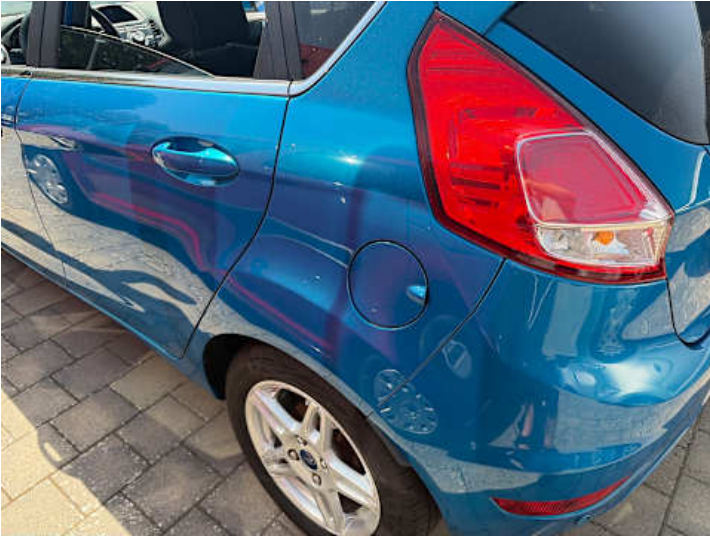
Seitenteil hinten links (Lackschaden)
