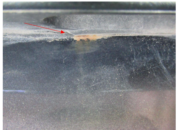
Bild 8: Außen, Heckklappe - Griffmulde, Rostbildung, instandsetzen und lackieren mit Lackaufbau
