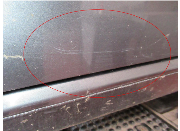
Bild 6: Außen, Tür vorne links - Lackierung, zerkratzt, polieren
