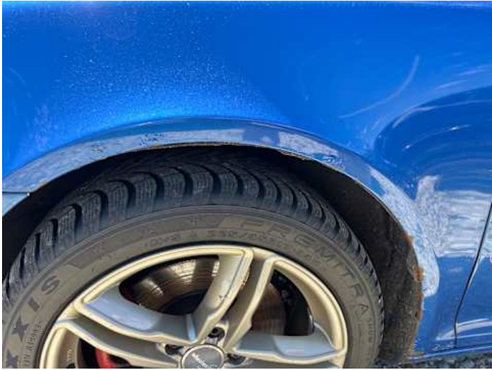
Kotflügel vorne links (Rost, Lackschaden)
