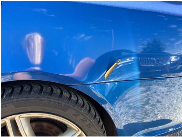
Seitenteil hinten links (Rost, Lackschaden)
