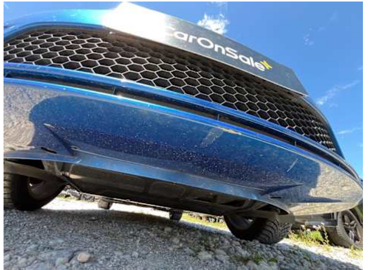
Stoßstange vorne (Kratzer, Lackschaden)
