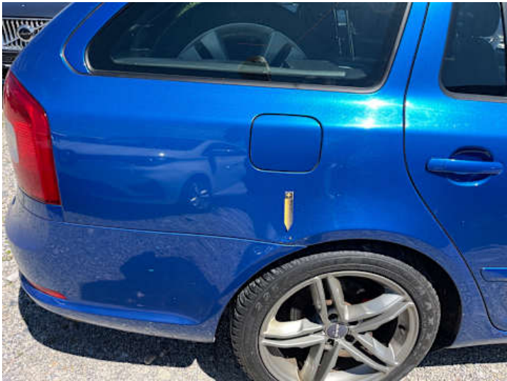
Seitenteil hinten rechts (Rost, Lackschaden)
