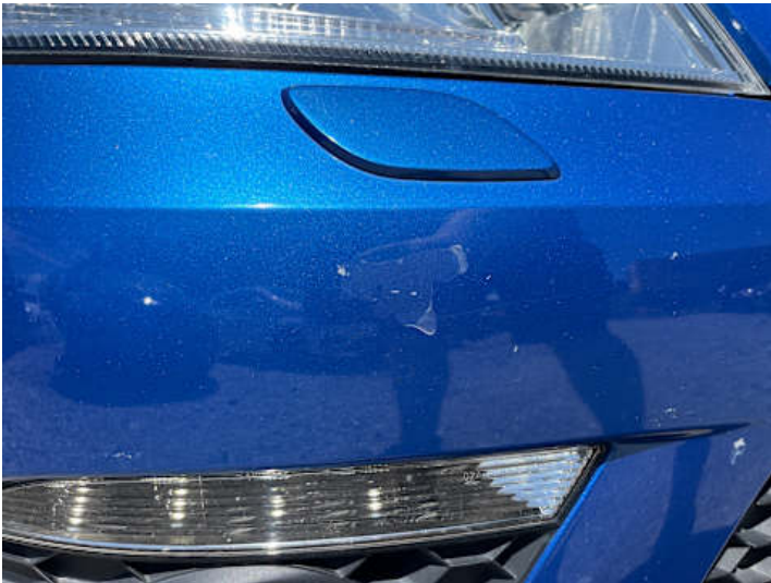
Stoßstange vorne (Kratzer, Lackschaden)
