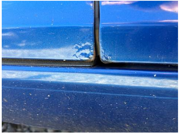
Fahrtür (Rost, Lackschaden)
