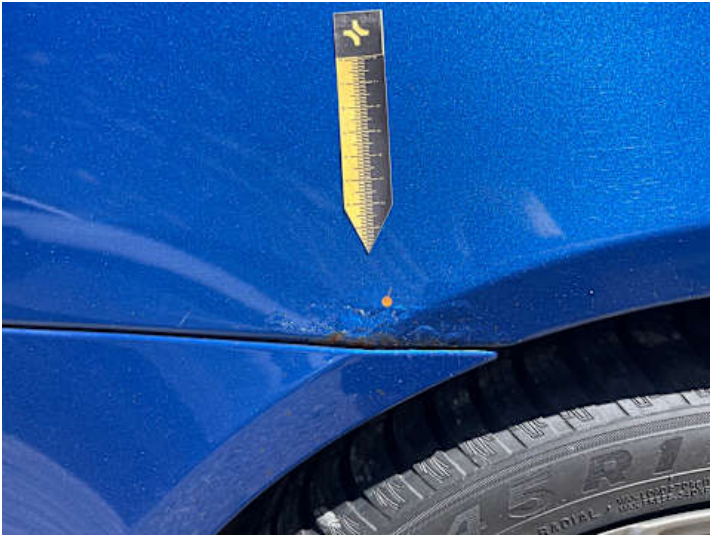
Seitenteil hinten rechts (Rost, Lackschaden)
