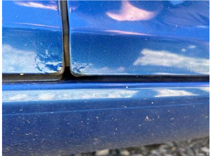
Türe hinten links (Rost, Lackschaden)
