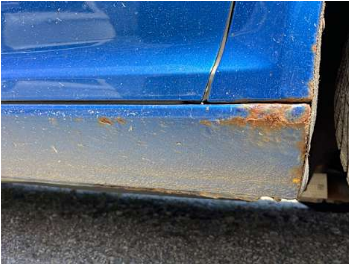
Schweller rechts (Rost, Lackschaden)
