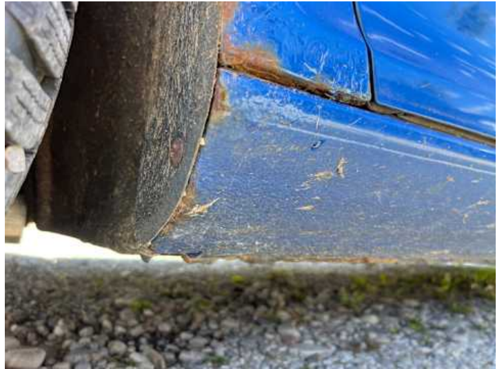
Schweller links (Rost, Lackschaden)
