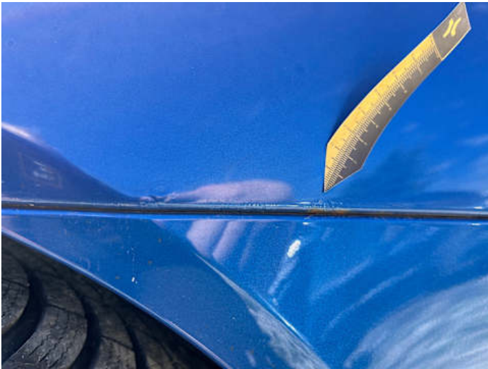
Seitenteil hinten links (Rost, Lackschaden)
