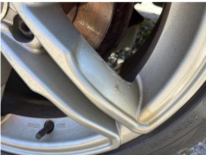
Rad (Kerben, Rost)
