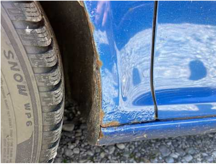
Kotflügel vorne links (Rost, Lackschaden)
