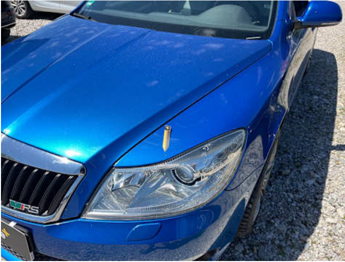
Kotflügel vorne links (Steinschlag)
