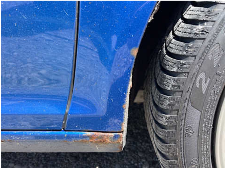
Kotflügel vorne rechts (Lackschaden, Rost)
