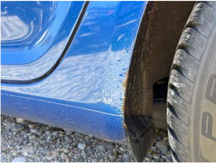
Seitenteil hinten links (Rost, Lackschaden)
