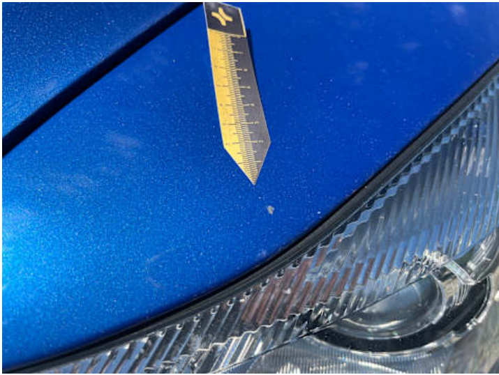
Kotflügel vorne links (Steinschlag)
