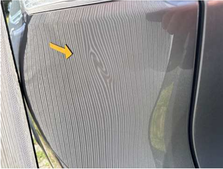
Seitenteil hinten links (Verformung, Kratzer)
