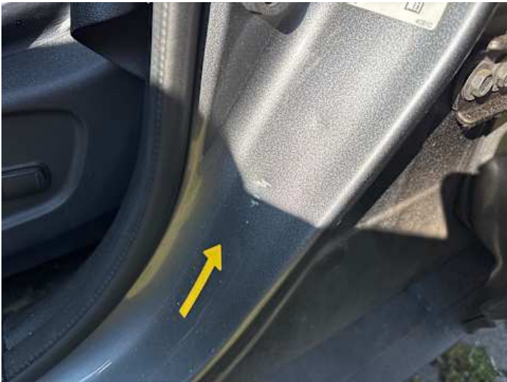
Schweller links (Kratzer, Delle)
