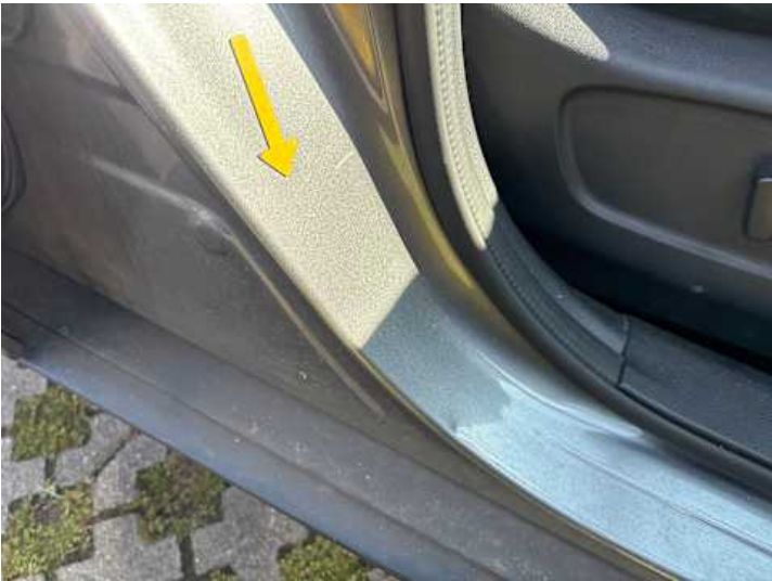
Schweller rechts (Kratzer, Delle)
