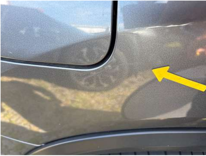
Seitenteil hinten rechts (Kratzer)
