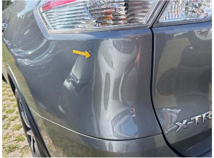
Seitenteil hinten links (Verformung, Kratzer)
