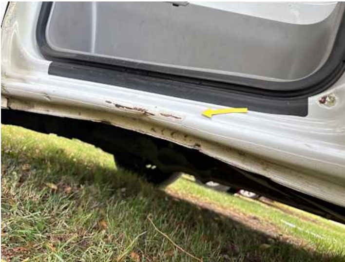
Schweller links (Rost, Verformung)
