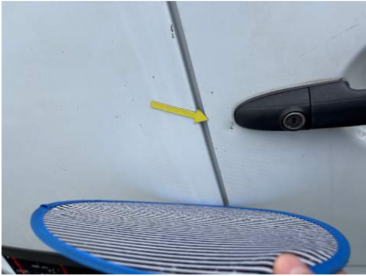
Heckklappe (Rost, Lackschaden, Delle)
