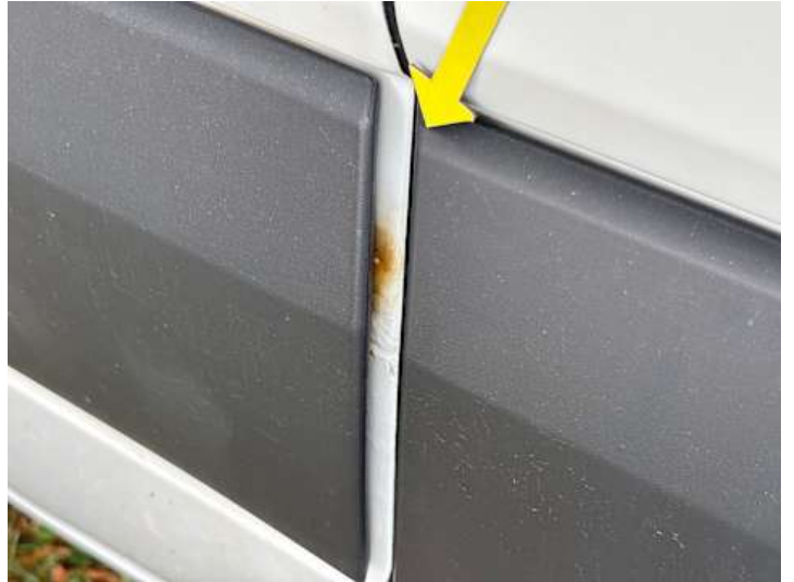
Seitenteil hinten links (Rost)
