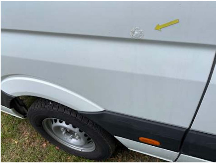
Seitenteil hinten rechts (Rost)
