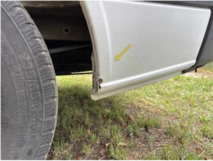
Seitenteil hinten links (Rost)
