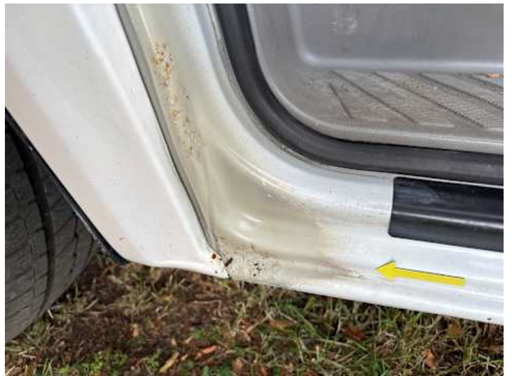
Fahrtür (Lackschaden, Rost, Unsachgemäß instand gesetzt)
