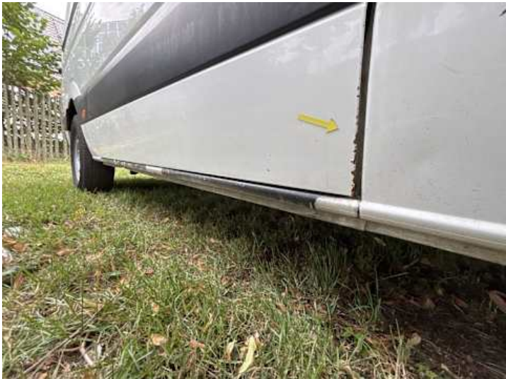
Türe hinten rechts (Rost)
