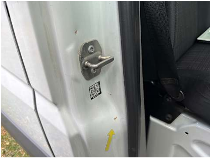
Beifahrertür (Kratzer, Rost, Delle)
