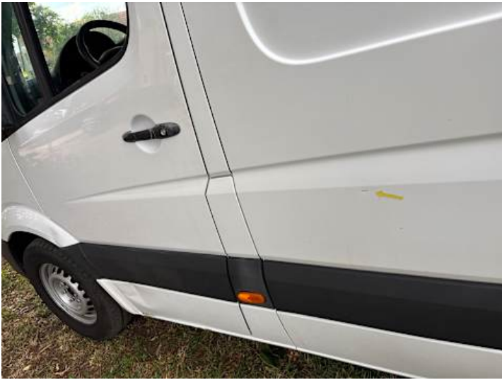
Seitenteil hinten links (Delle, Kratzer)
