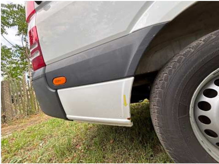
Seitenteil hinten rechts (Rost)
