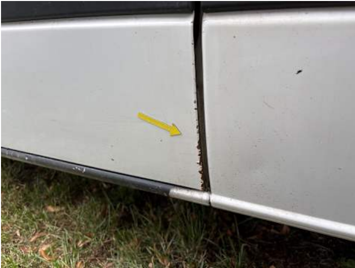
Türe hinten rechts (Rost)
