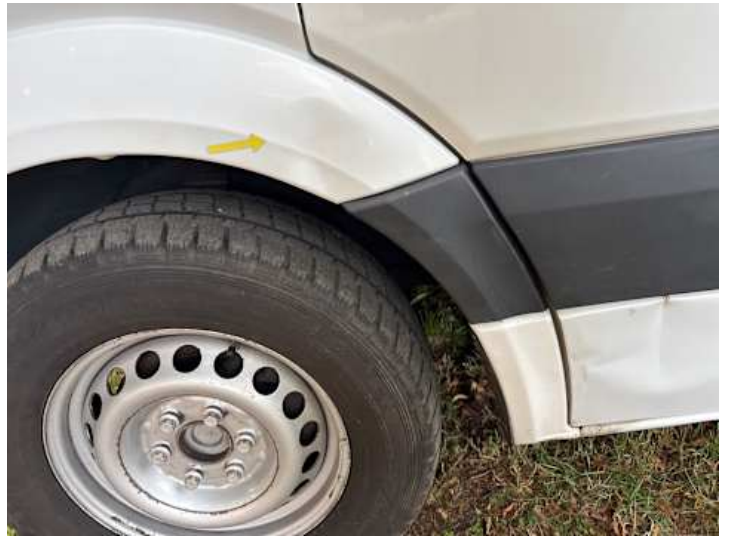
Kotflügel vorne links (Verformung, Kratzer)
