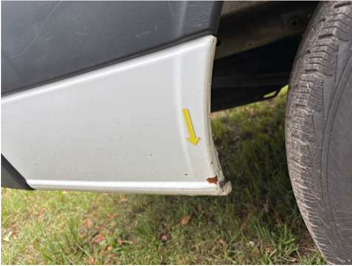
Seitenteil hinten rechts (Rost)
