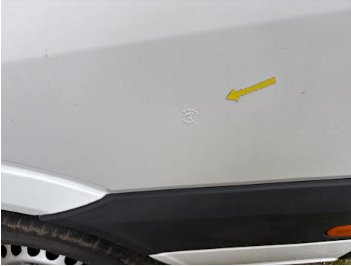
Seitenteil hinten links (Rost)
