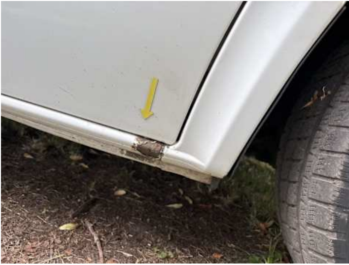
Schweller rechts (Rost)
