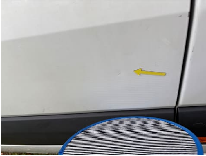
Türe hinten rechts (Kratzer, Delle)
