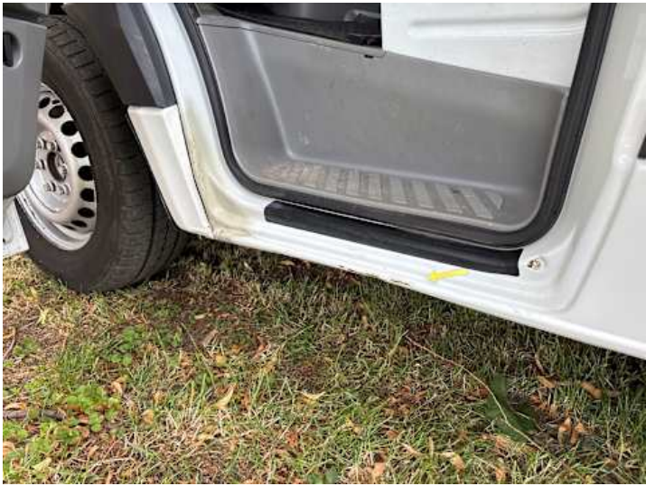
Schweller links (Rost, Verformung)
