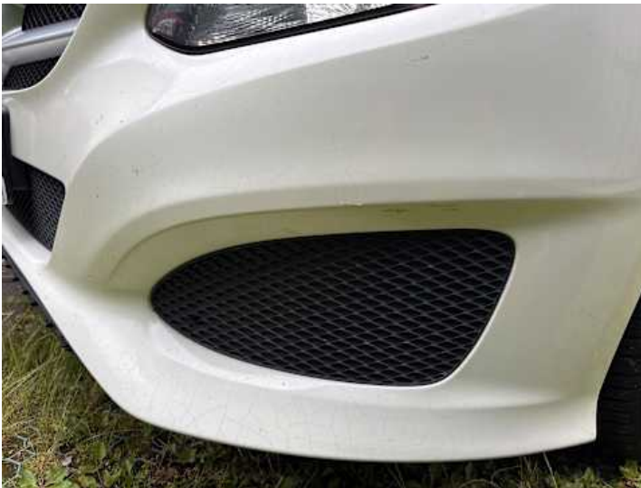
Stoßstange vorne (Unsachgemäß instand gesetzt, Kratzer)
