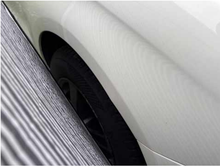
Kotflügel vorne rechts (Verformung)
