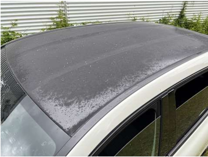
Dach (Anderer Schaden): Folie matt und löst sich an manchen Stellen
