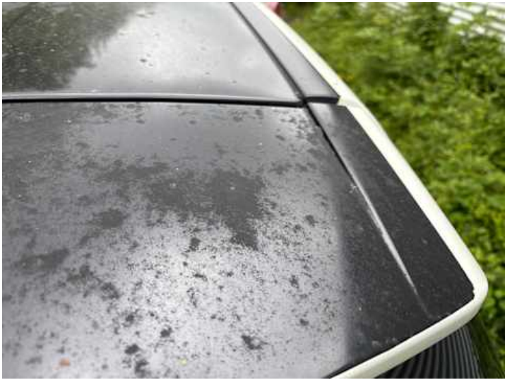
Heckklappe (Anderer Schaden): Folie matt und löst sich an manchen Stellen
