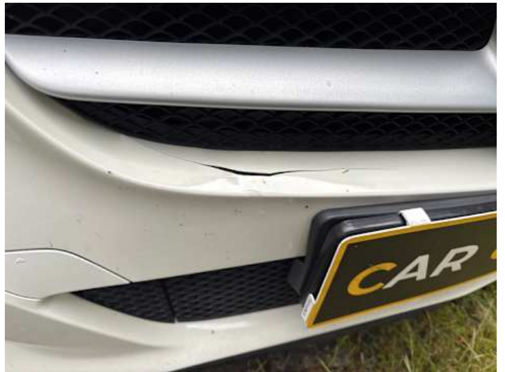
Stoßstange vorne (Unsachgemäß instand gesetzt, Riss/Bruch, Kratzer)
