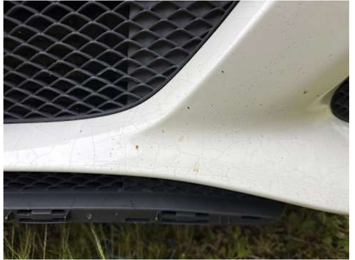
Stoßstange vorne (Unsachgemäß instand gesetzt, Kratzer)
