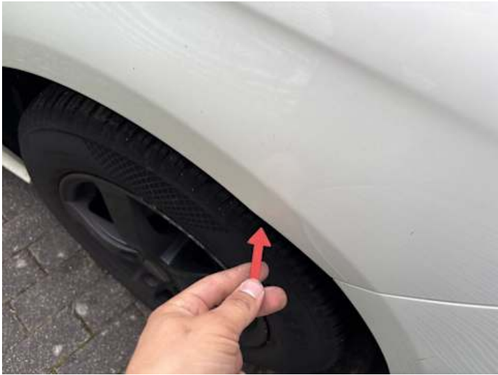
Kotflügel vorne rechts (Verformung)
