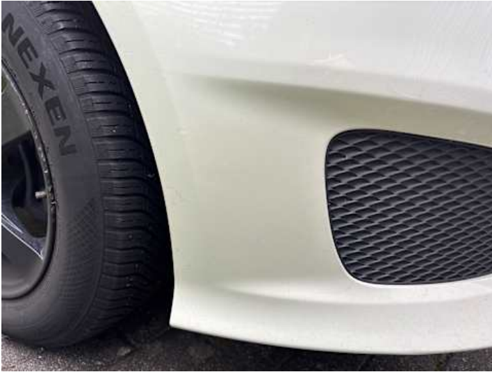
Stoßstange vorne (Unsachgemäß instand gesetzt, Kratzer)
