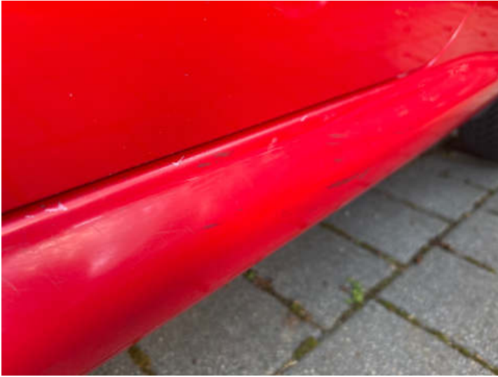
Schweller links (Kratzer, Lackschaden)
