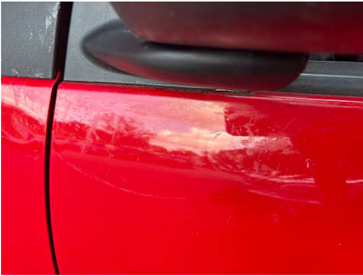
Fahrrertür (Lackschaden, Rost)
