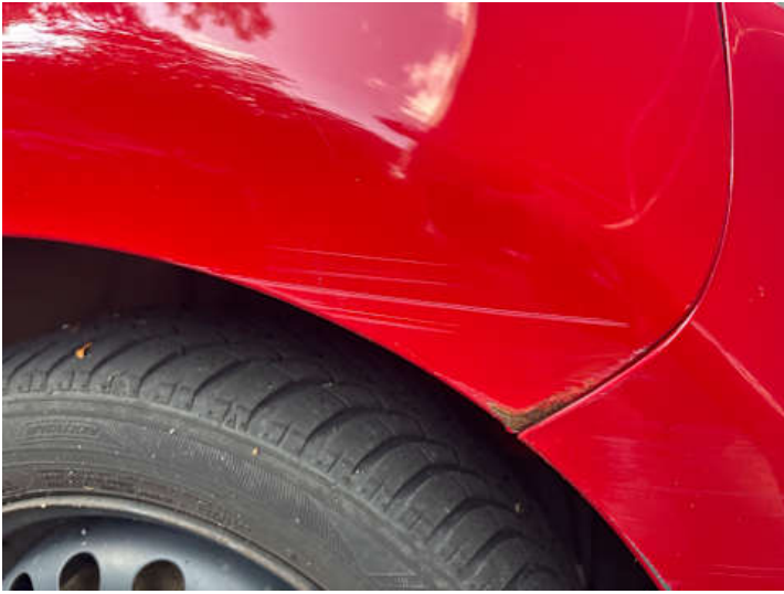
Kotflügel vorne rechts (Kratzer, Lackschaden, Verformung, Rost)
