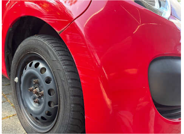
Stoßstange vorne (Ausgeblichen/Matt, Kratzer, Lackschaden, Verformung)
