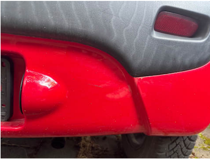
Stoßstange hinten (Kratzer, Lackschaden, Ausgeblichen/Matt)
