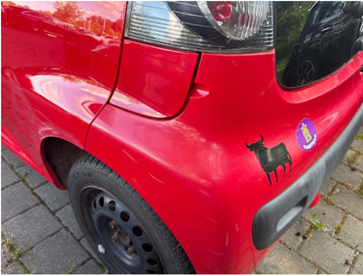
Stoßstange hinten (Kratzer, Lackschaden, Ausgeblichen/Matt)
