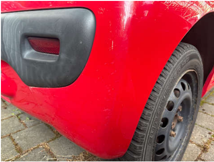
Stoßstange hinten (Kratzer, Lackschaden, Ausgeblichen/Matt)
