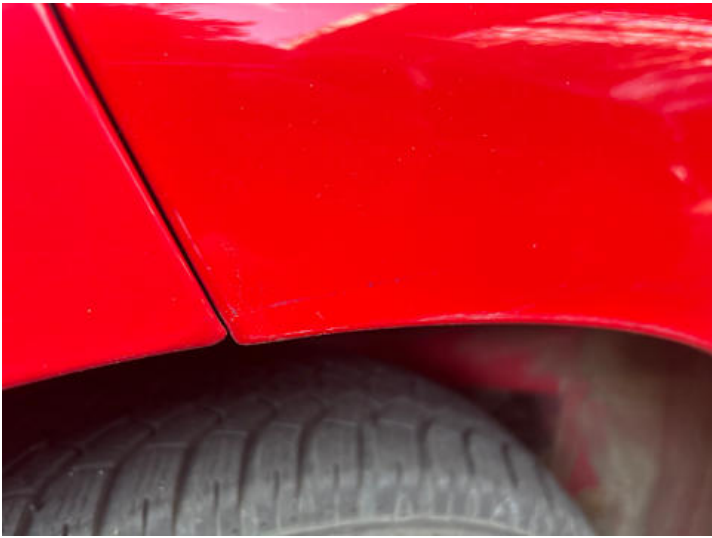
Seitenteil hinten rechts (Kratzer, Lackschaden)
