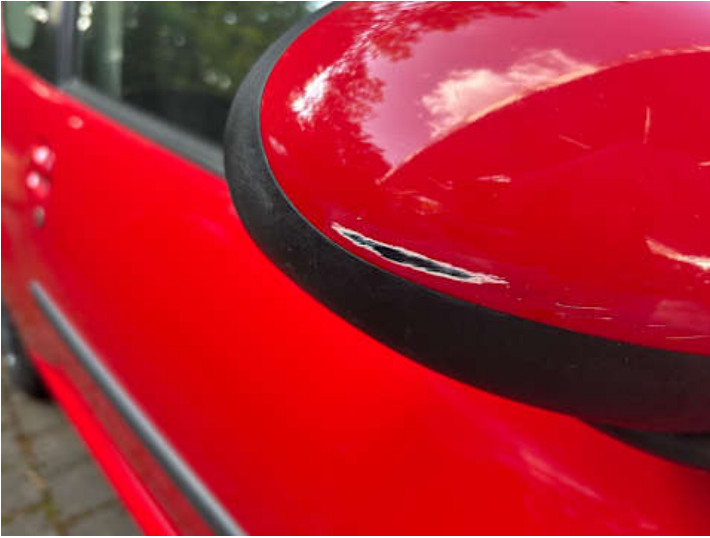
Beifahrertür (Kratzer, Lackschaden)
