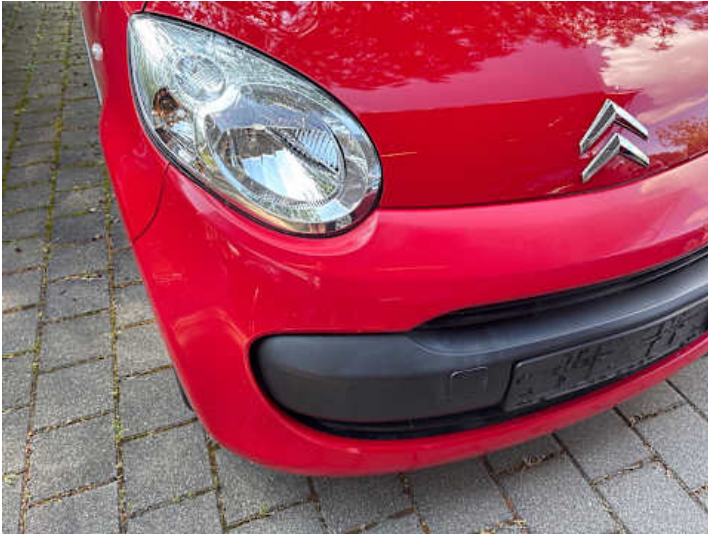
Stoßstange vorne (Ausgeblichen/Matt, Kratzer, Lackschaden, Verformung)
