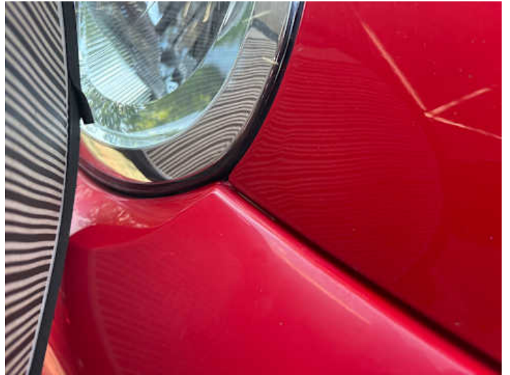
Motorhaube (Delle, Verformung)
