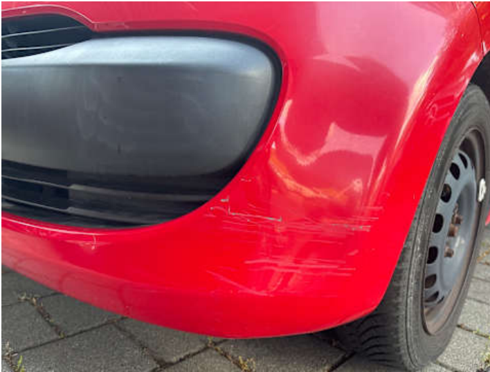
Stoßstange vorne (Ausgeblichen/Matt, Kratzer, Lackschaden, Verformung)
