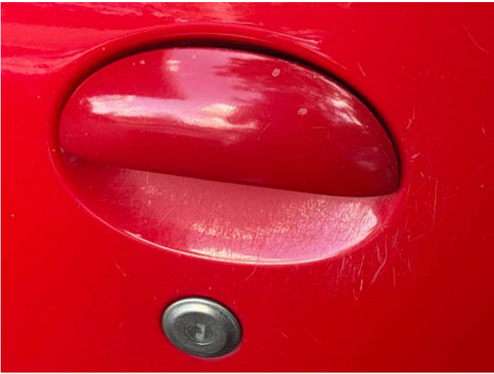
Fahrrertür (Kratzer, Lackschaden)
