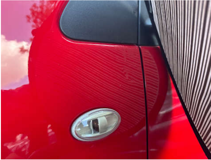
Kotflügel vorne links (Delle)
