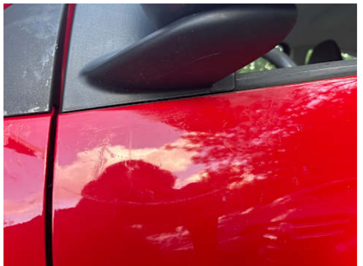
Fahrertür (Lackschaden, Rost)
