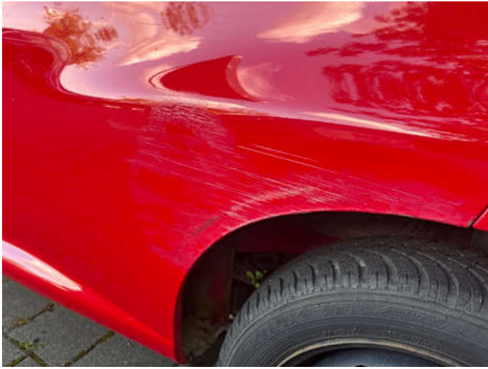
Seitenteil hinten links (Kratzer, Lackschaden, Verformung)
