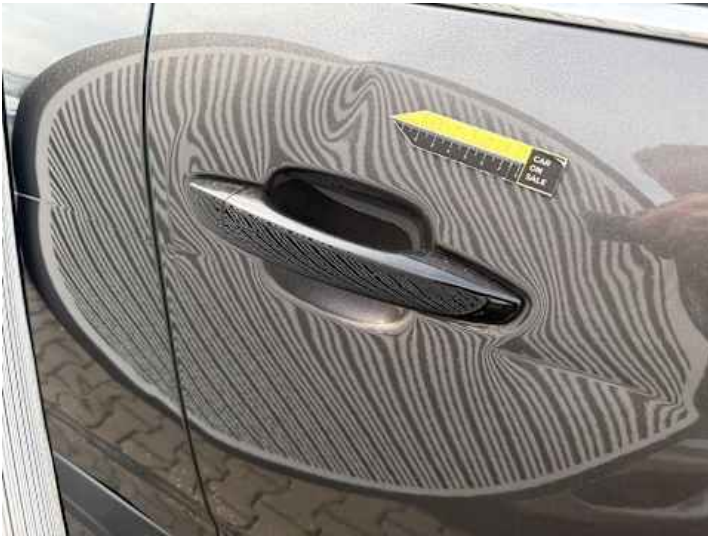
Beifahrertür (Verformung, Delle)
