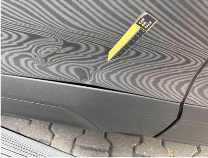
Türe hinten rechts (Verformung, Kratzer)
