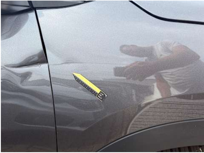
Kotflügel vorne rechts (Verformung)
