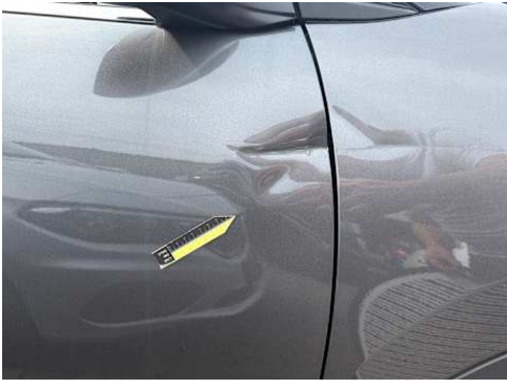
Beifahrertür (Verformung, Delle)
