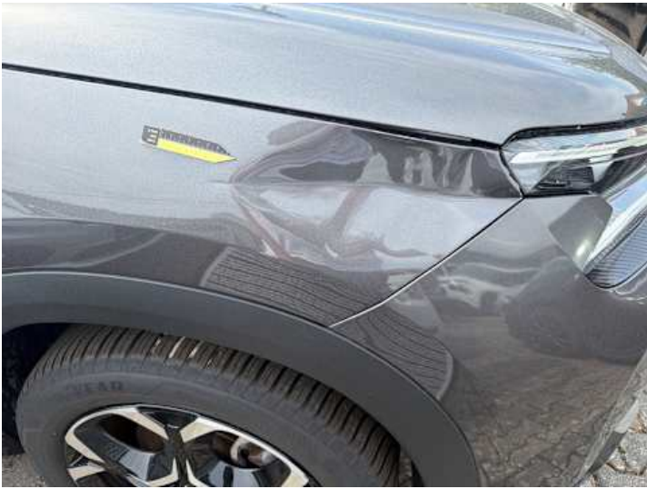
Kotflügel vorne rechts (Verformung)
