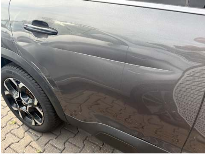
Türe hinten rechts (Verformung, Kratzer)
