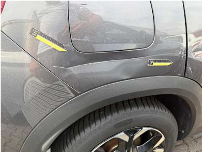
Schweller rechts (Verformung)
