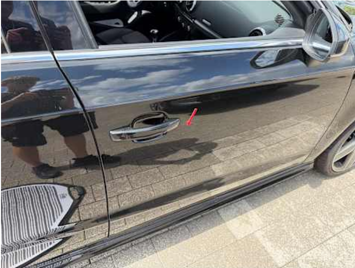
Beifahrertür (Kratzer, Lackschaden)
