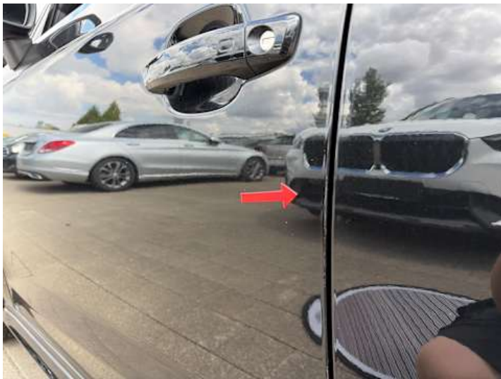
Fahrtür (Kratzer, Delle, Lackschaden)
