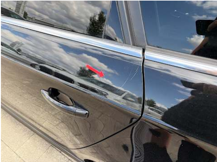
Türe hinten links (Kratzer, Lackschaden, Delle)
