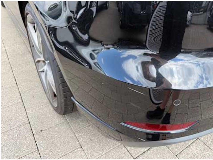
Stoßstange hinten (Kratzer, Lackschaden, Verformung)
