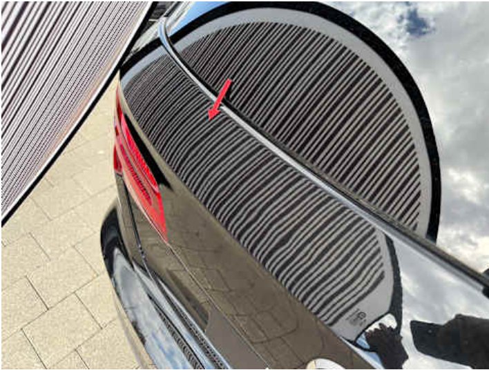
Heckklappe (Kratzer, Lackschaden, Delle)
