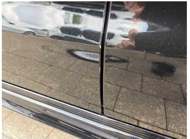
Fahrtür (Kratzer, Delle, Lackschaden)
