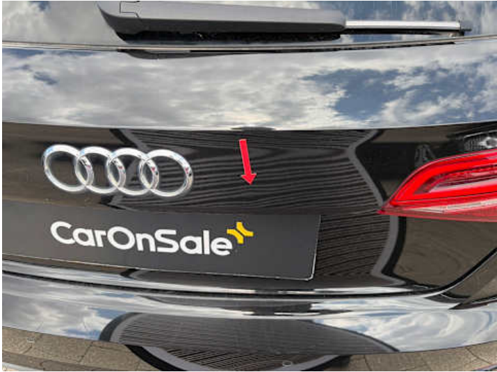
Heckklappe (Kratzer, Lackschaden, Delle)
