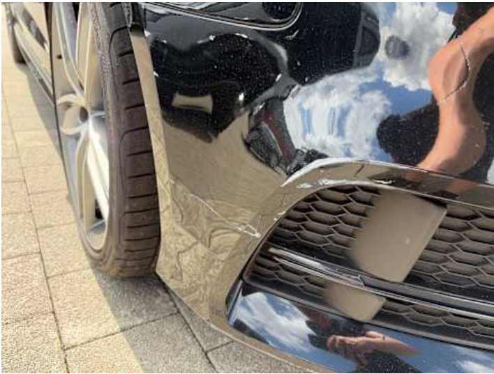
Stoßstange vorne (Kratzer, Lackschaden)
