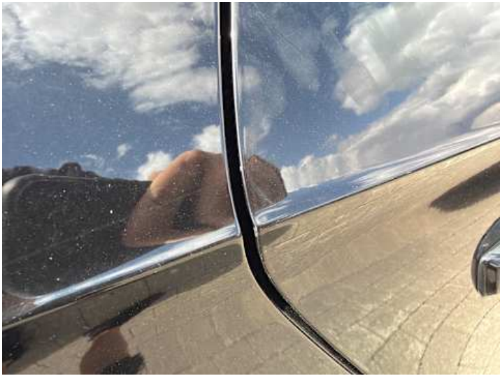
Türe hinten rechts (Delle, Lackschaden, Kratzer)
