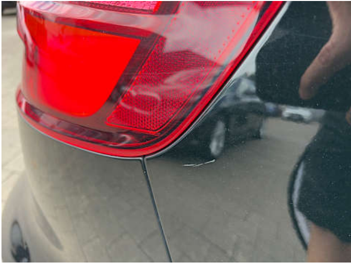
Seitenteil hinten rechts (Kratzer, Lackschaden, Delle)
