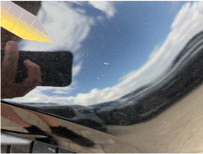
Kotflügel vorne rechts (Steinschlag, Lackschaden)
