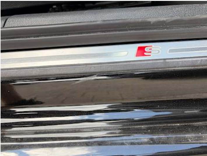
Beifahrertür (Kratzer, Lackschaden)
