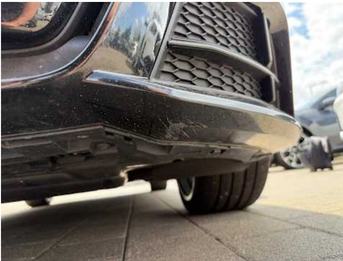
Stoßstange vorne (Kratzer, Lackschaden)
