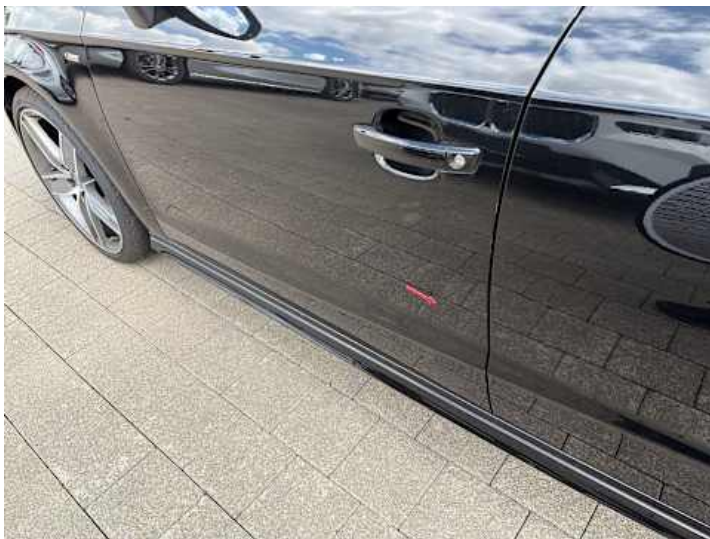
Fahrtür (Kratzer, Delle, Lackschaden)
