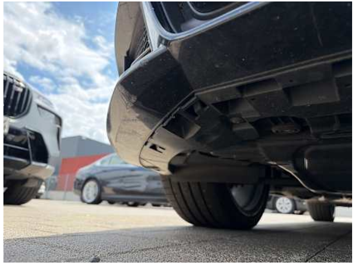
Stoßstange vorne (Kratzer, Lackschaden)
