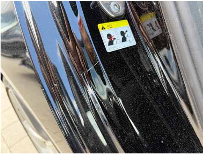
Türe hinten rechts (Delle, Lackschaden, Kratzer)
