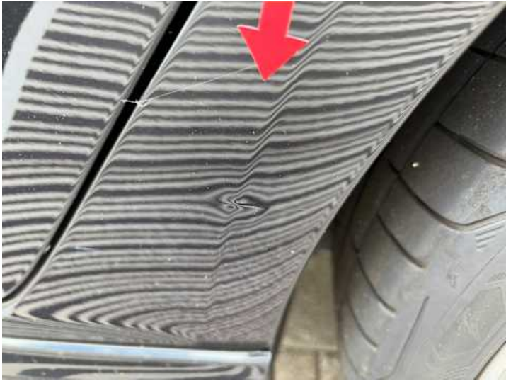
Seitenteil hinten links (Delle, Lackschaden, Kratzer)
