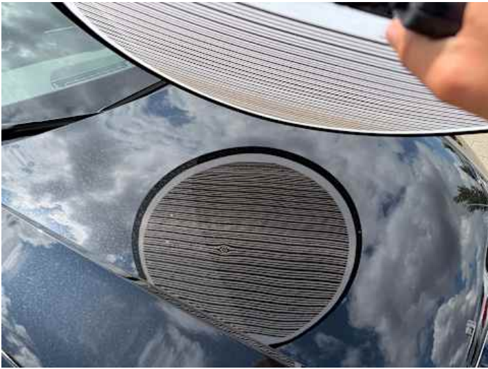
Motorhaube (Lackschaden, Delle, Steinschlag)
