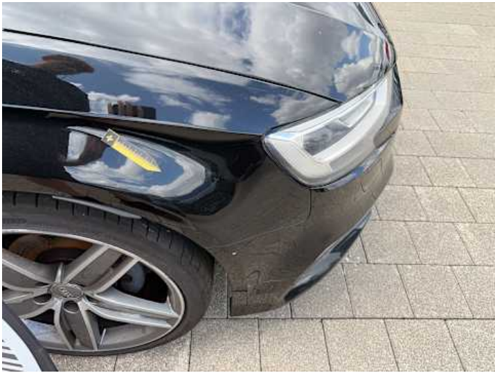
Kotflügel vorne rechts (Steinschlag, Lackschaden)
