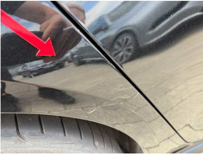
Seitenteil hinten rechts (Kratzer, Lackschaden, Delle)
