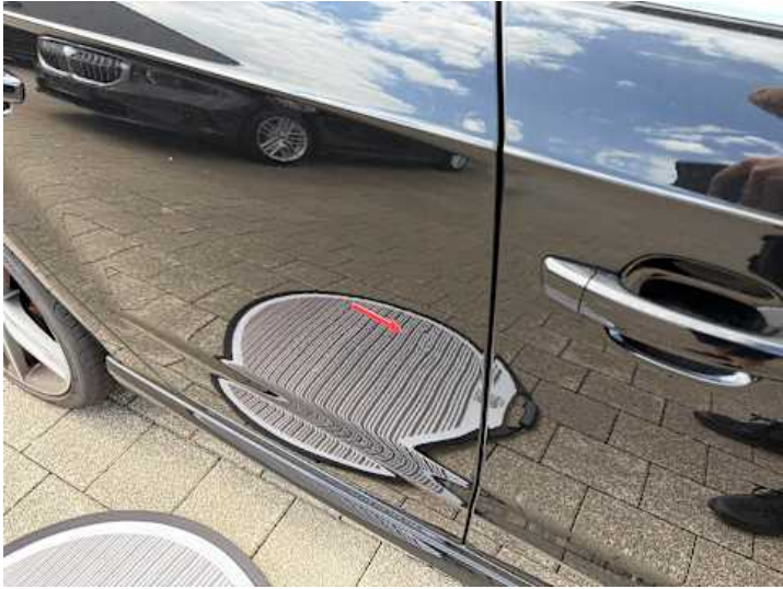
Türe hinten rechts (Delle, Lackschaden, Kratzer)
