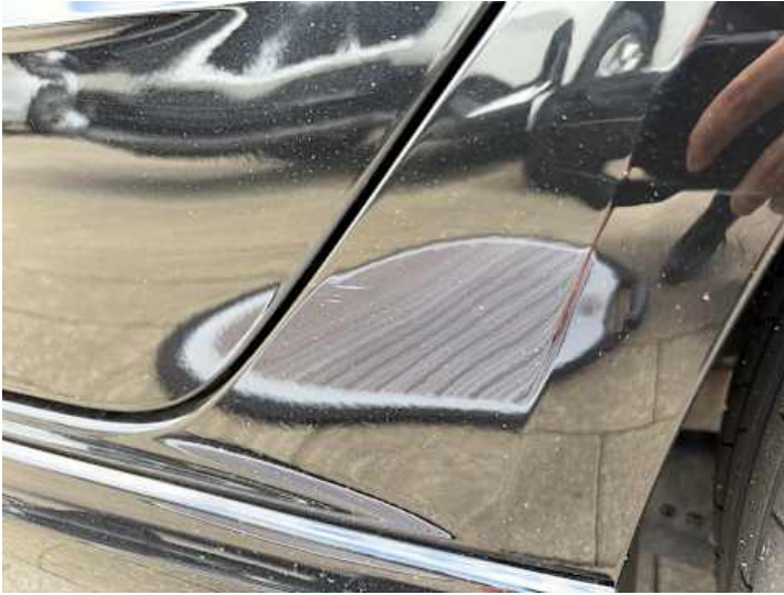
Seitenteil hinten links (Delle, Lackschaden, Kratzer)
