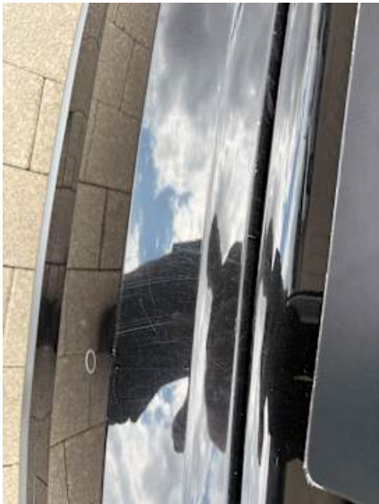
Stoßstange hinten (Kratzer, Lackschaden, Verformung)
