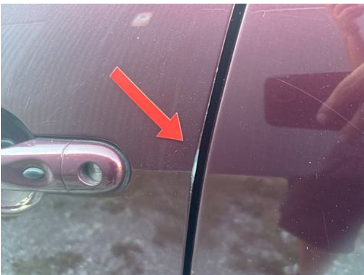
Fahrertür (Lackschaden, Verformung)
