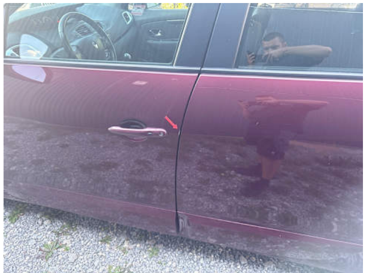
Fahrertür (Lackschaden, Verformung)
