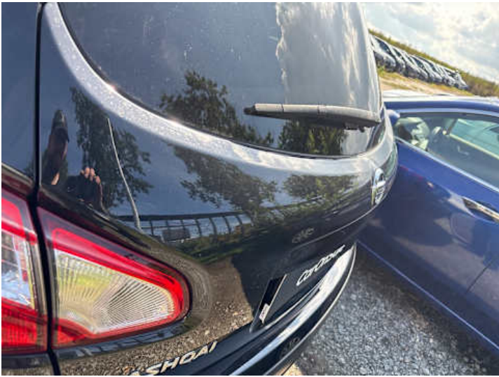
Heckklappe (Unsachgemäß instand gesetzt)
