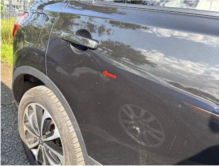
Türe hinten rechts (Delle)
