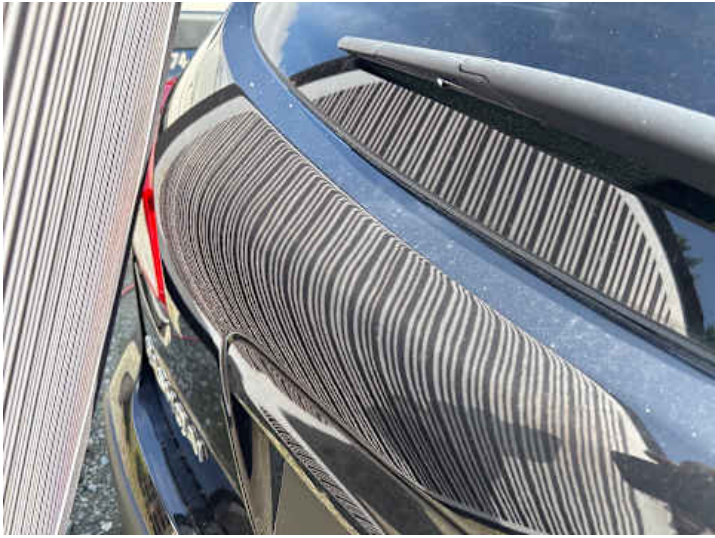
Heckklappe (Unsachgemäß instand gesetzt)
