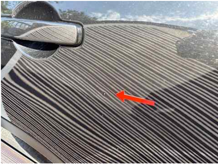
Türe hinten rechts (Delle)
