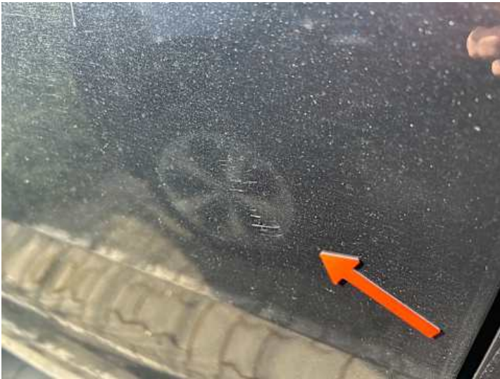
Türe hinten rechts (Kratzer)
