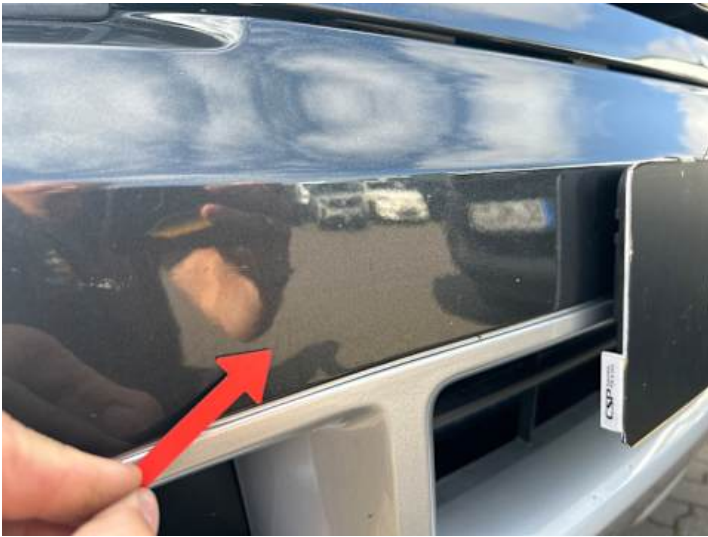
Stoßstange vorne (Verformung)
