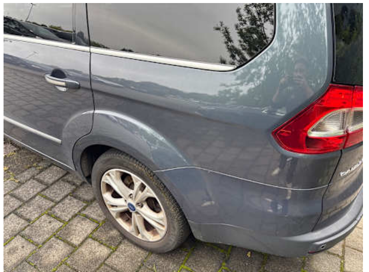
Seitenteil hinten links (Anderer Schaden, Unsachgemäß instand gesetzt): Farbunterschied
