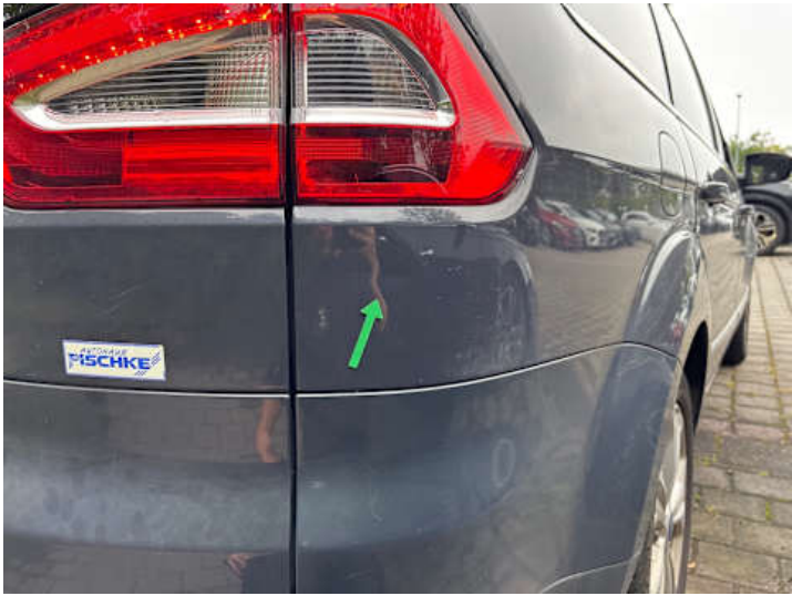
Seitenteil hinten rechts (Delle, Verformung)
