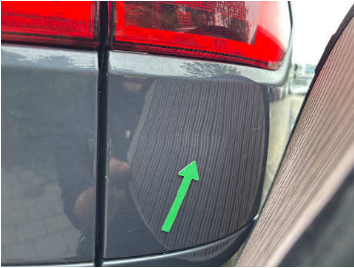
Seitenteil hinten rechts (Delle, Verformung)
