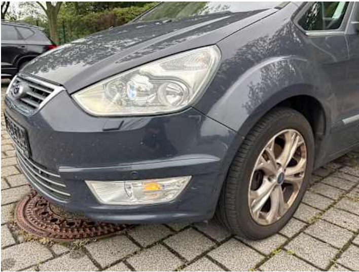
Stoßstange vorne (Unsachgemäß instand gesetzt, Anderer Schaden): Farbunterschied
