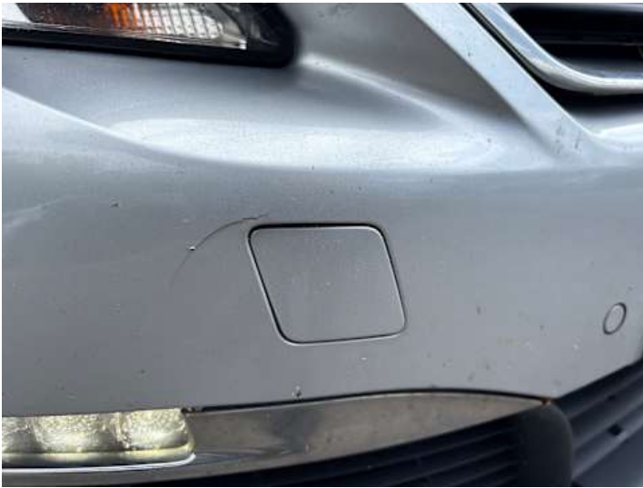
Stoßstange vorne (Riss/Bruch)
