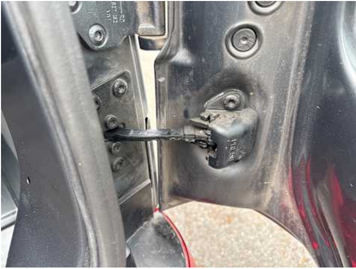
Heckklappe (Anderer Schaden): Schraube locker/knackt
