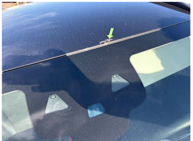
Dach (Lackschaden, Verformung)
