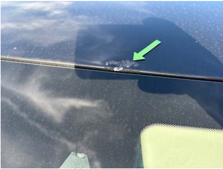
Dach (Lackschaden, Verformung)
