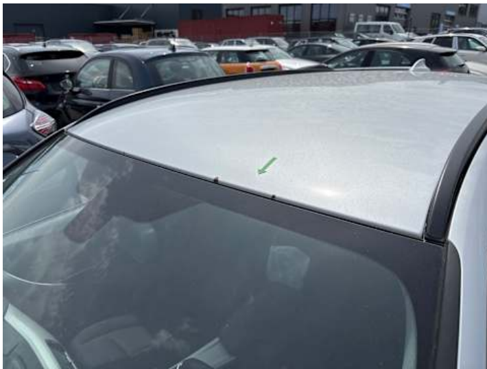
Dach (Lackschaden, Rost)
