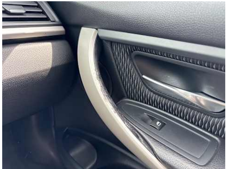
Innenraum (Verschleiß, Diverse Schäden)
