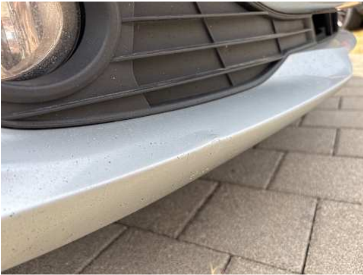
Stoßstange vorne (Verformung)
