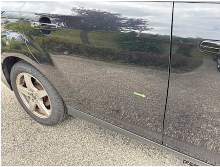
Türe hinten rechts (Delle, Kratzer)
