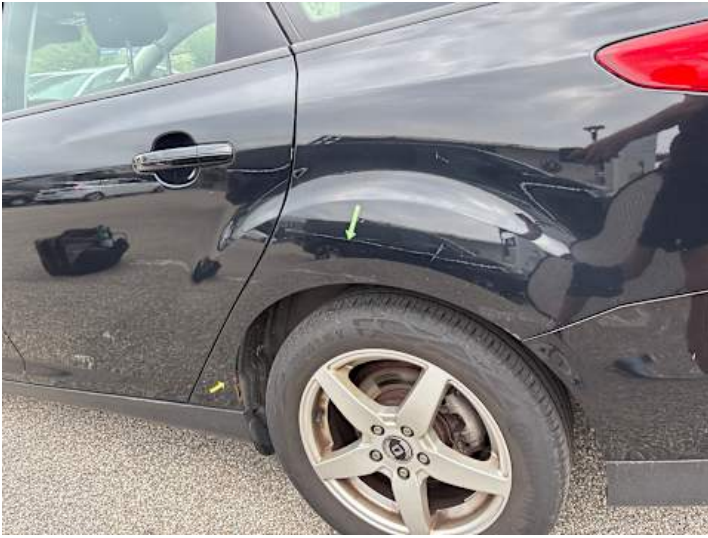
Seitenteil hinten links (Delle, Rost)
