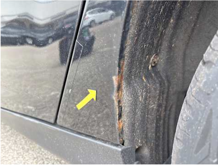
Seitenteil hinten links (Delle, Rost)
