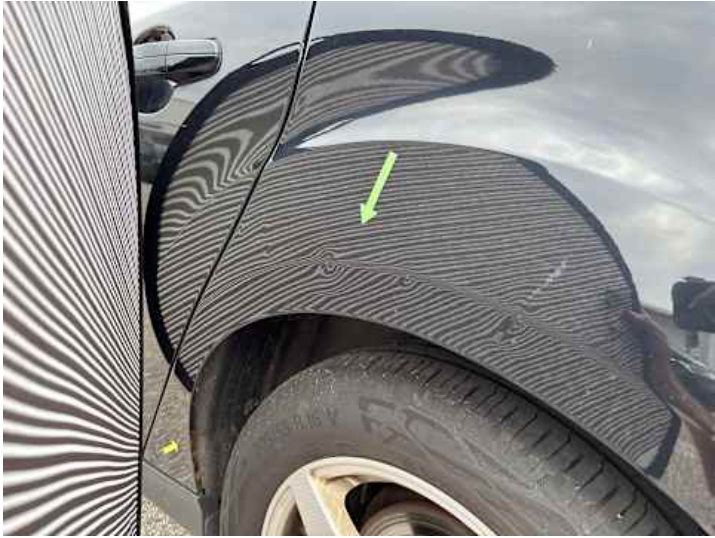
Seitenteil hinten links (Delle, Rost)
