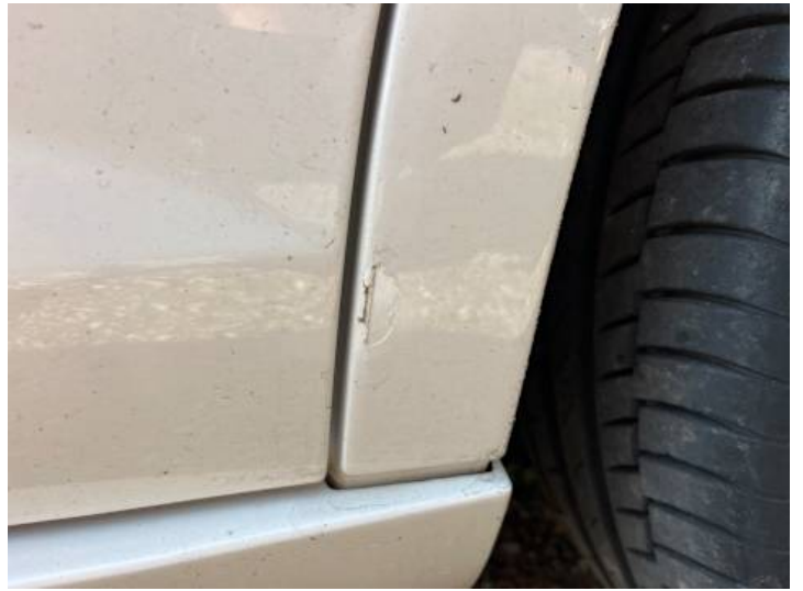
Seitenteil hinten links (Lackschaden, Unsachgemäß instand gesetzt)
