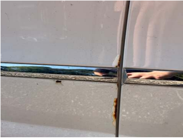
Fahrtür (Lackschaden, Rost, Unsachgemäß instand gesetzt)
