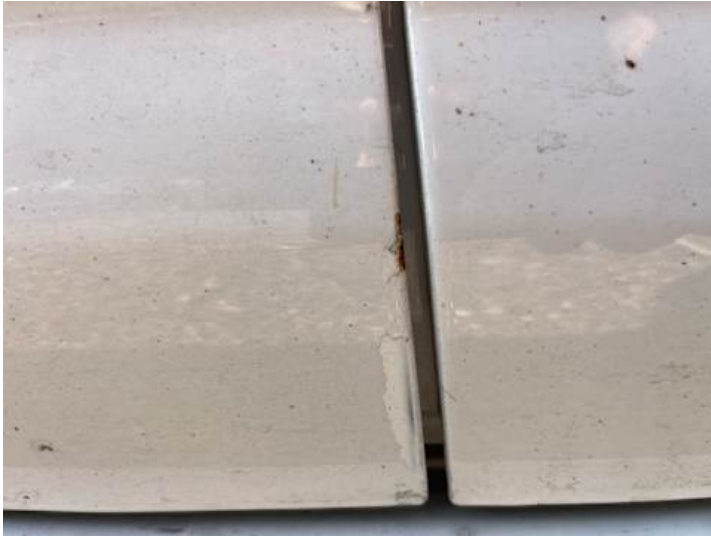
Fahrtür (Lackschaden, Rost, Unsachgemäß instand gesetzt)
