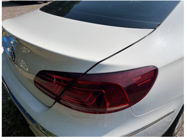
Heckklappe (Spaltmaße ungenau)
