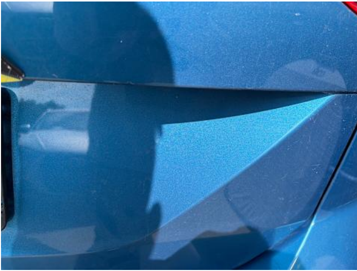
Heckklappe (Lackschaden, Kratzer)
