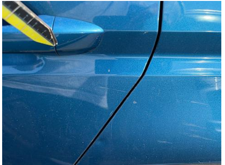
Türe hinten links (Lackschaden, Kratzer)
