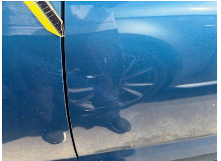
Türe hinten links (Lackschaden, Kratzer)
