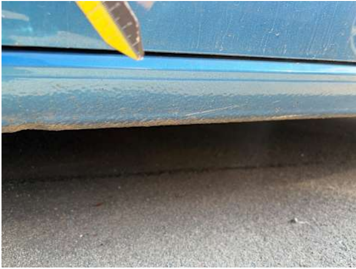
Schweller links (Lackschaden, Kratzer)
