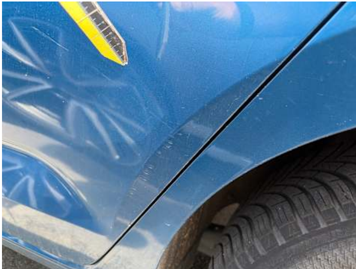
Türe hinten links (Lackschaden, Kratzer)
