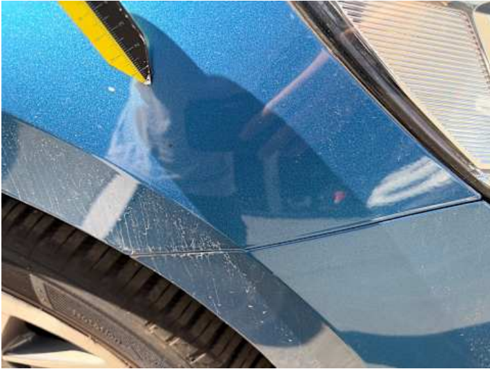
Kotflügel vorne rechts (Lackschaden, Kratzer)
