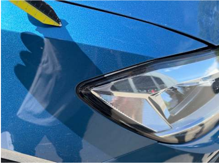
Kotflügel vorne rechts (Lackschaden, Kratzer)
