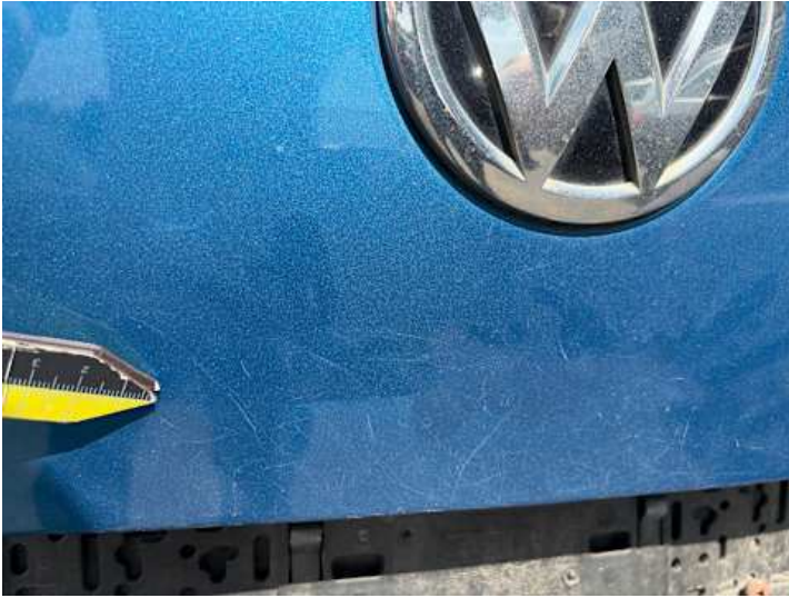
Heckklappe (Lackschaden, Kratzer)
