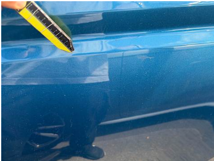
Türe hinten links (Lackschaden, Kratzer)
