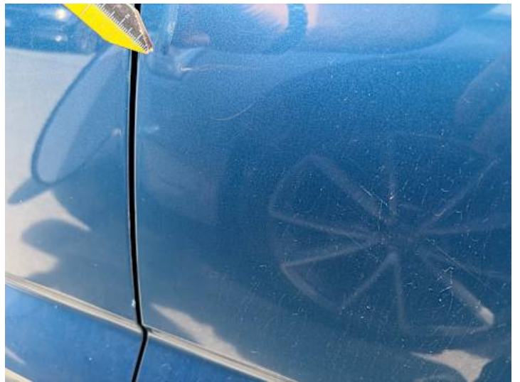
Türe hinten links (Lackschaden, Kratzer)
