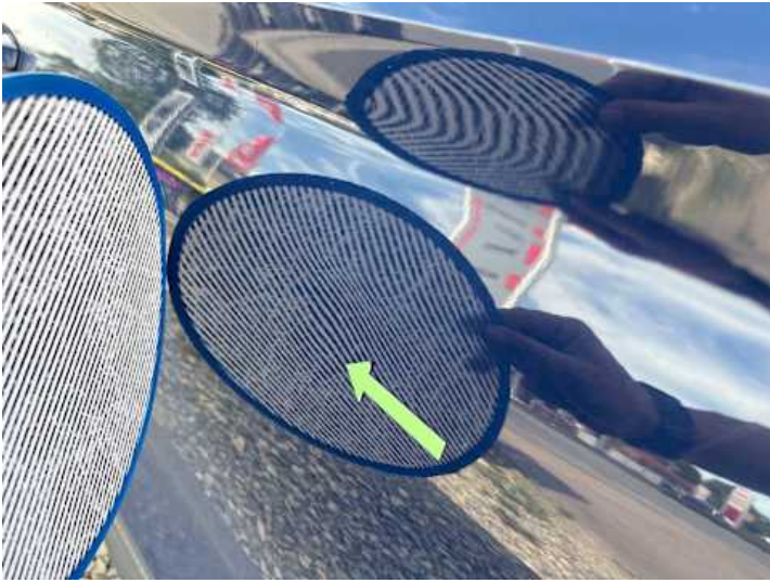
Türe hinten rechts (Delle, Kratzer)
