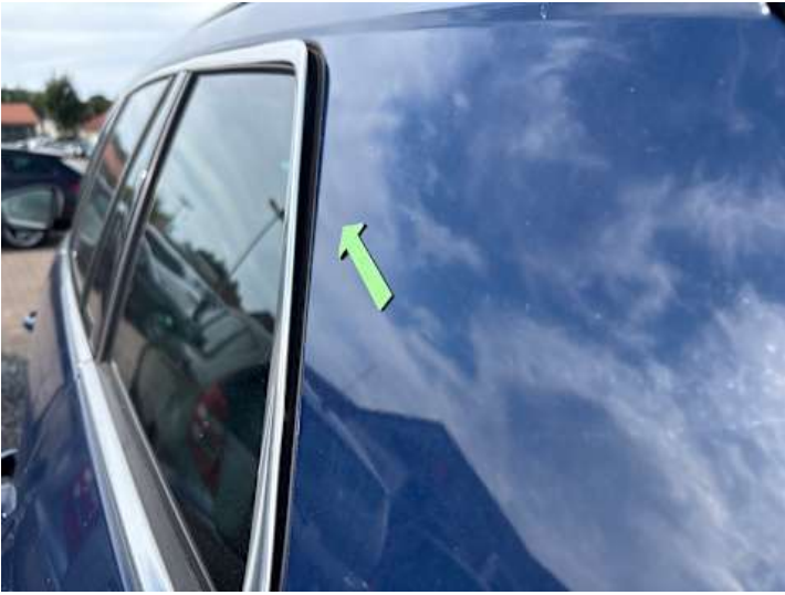
Seitenteil hinten links (Verformung)
