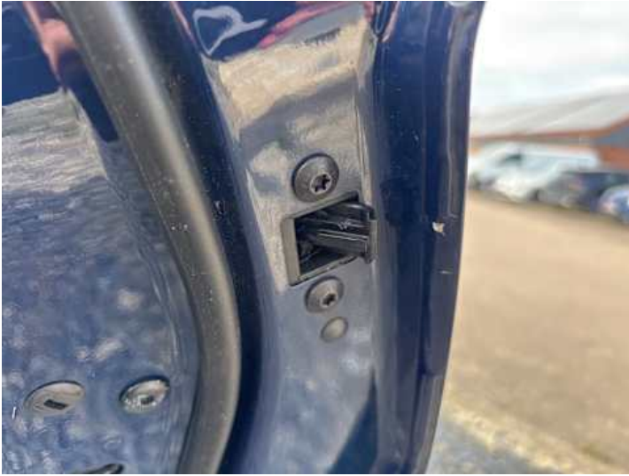
Türe hinten rechts (Riss/Bruch)
