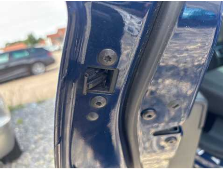
Türe hinten links (Riss/Bruch)
