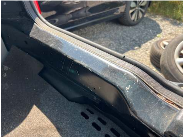
Heckklappe (Kratzer, Lackschaden)
