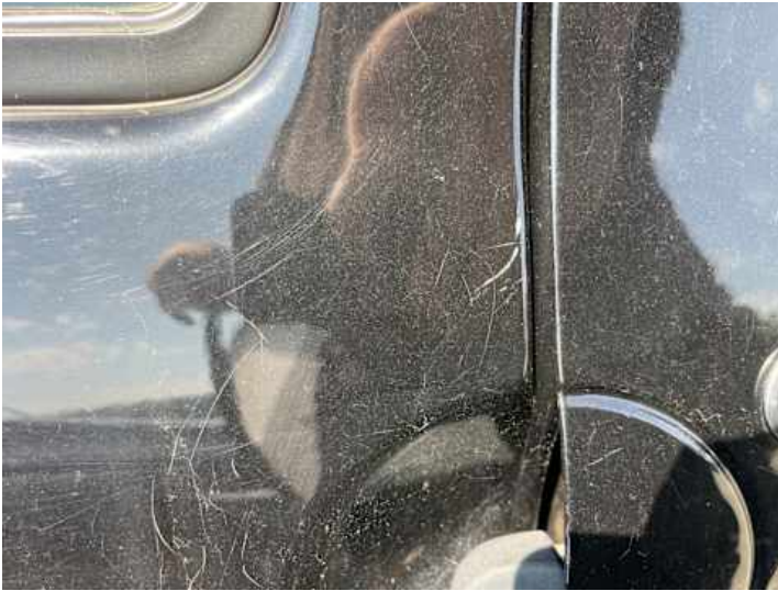
Seitenteil hinten rechts (Kratzer, Lackschaden, Rost, Unsachgemäß instand gesetzt)
