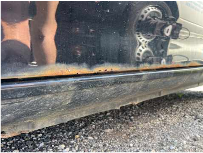
Fahrrertür (Lackschaden, Rost)
