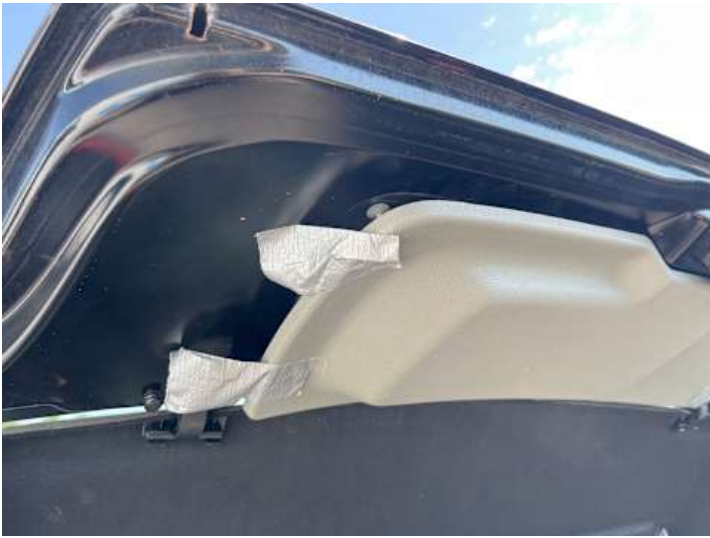
Heckklappe (Unsachgemäß instand gesetzt, Riss/Bruch)
