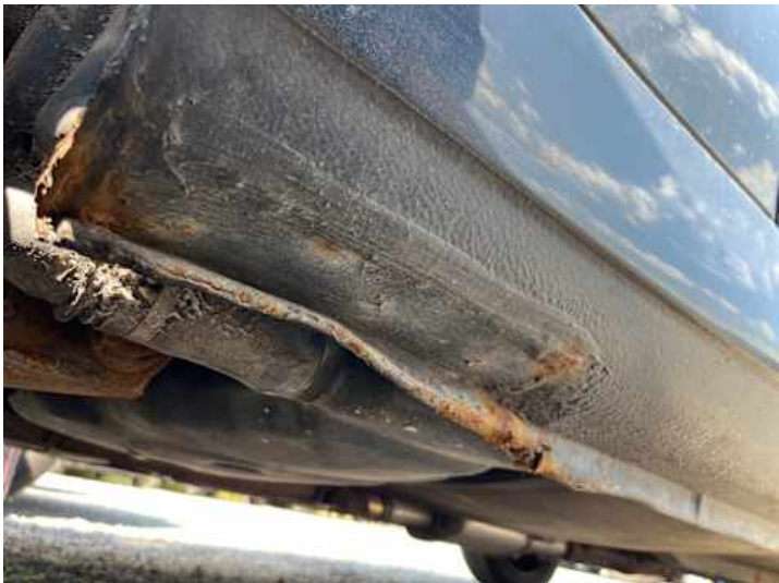
Schweller rechts (Lackschaden, Rost, Unsachgemäß instand gesetzt, Verformung)
