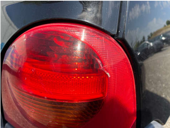
Rücklicht (rechts) (Riss/Bruch)
