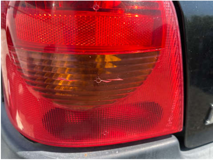
Rücklicht (links) (Riss/Bruch)
