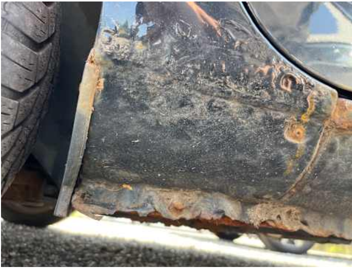
Kotflügel vorne links (Rost, Lackschaden)
