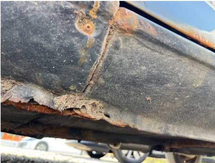
Schweller links (Rost, Lackschaden)
