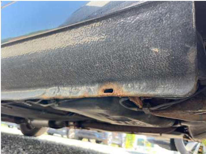
Schweller links (Rost, Lackschaden)
