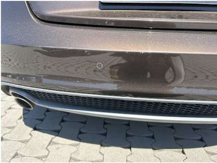
Stoßstange hinten (Kratzer, Verformung)
