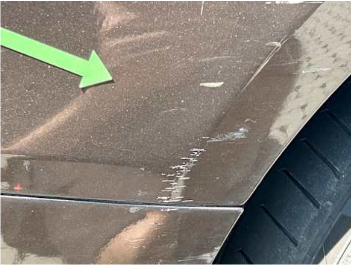
Seitenteil hinten rechts (Kratzer)
