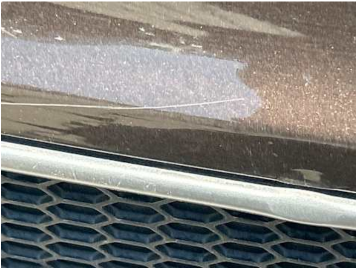
Stoßstange hinten (Kratzer, Verformung)
