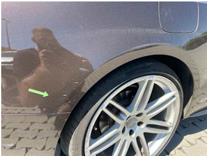
Seitenteil hinten rechts (Kratzer)
