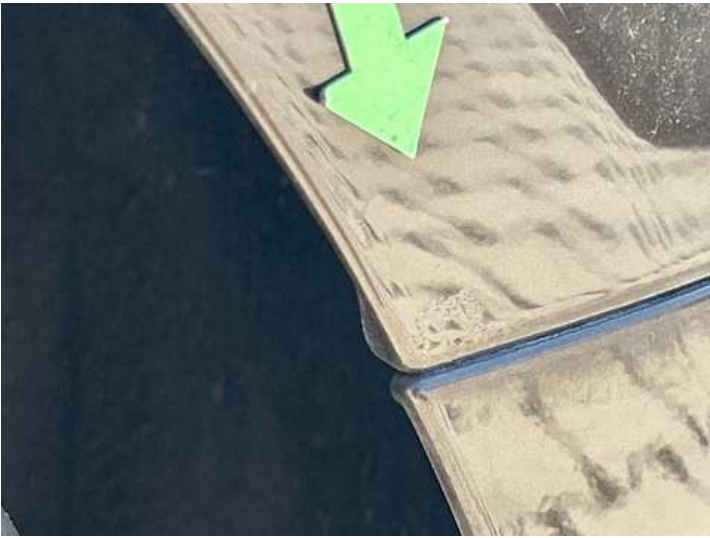
Seitenteil hinten links (Rost)
