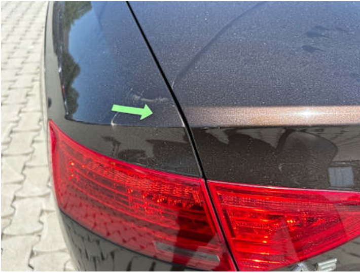
Seitenteil hinten links (Lackschaden)
