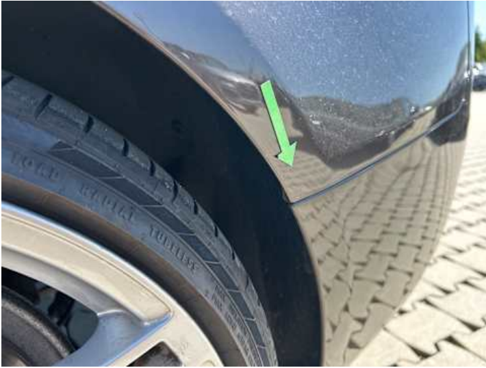
Seitenteil hinten links (Rost)
