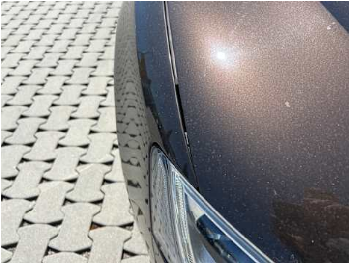
Kotflügel vorne rechts (Spaltmaße ungenau)
