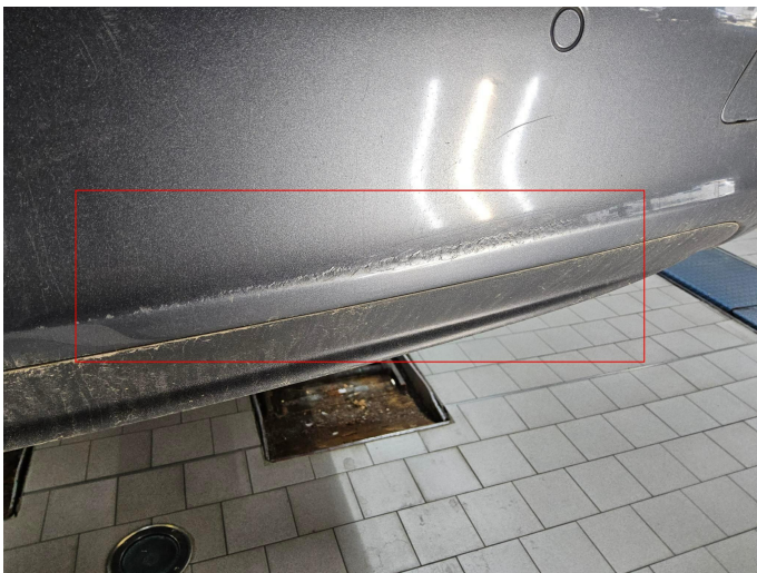
Bild 7: Außen, Stoßfänger hinten - Lackierung, verschrammt, lackieren
