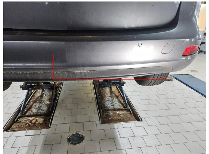
Bild 6: Außen, Stoßfänger hinten - Lackierung, verschrammt, lackieren
