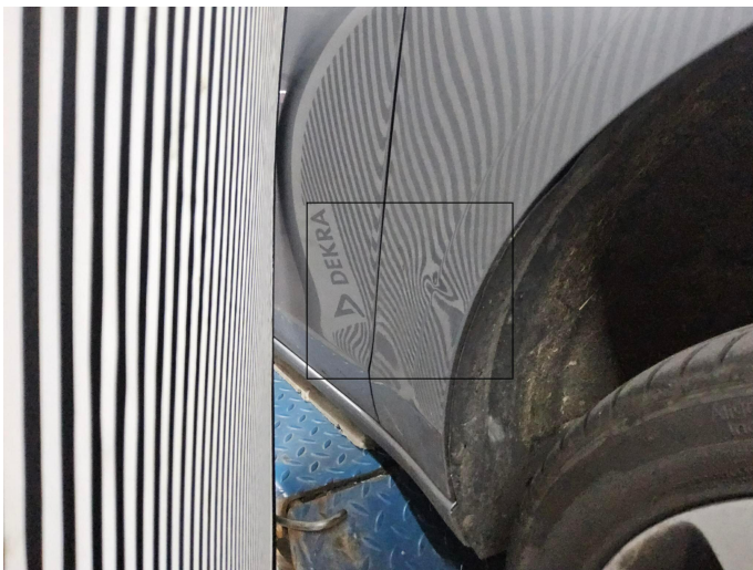
Bild 3: Außen, Kotflügel vorne rechts, deformiert, instandsetzen und lackieren mit Lackaufbau
