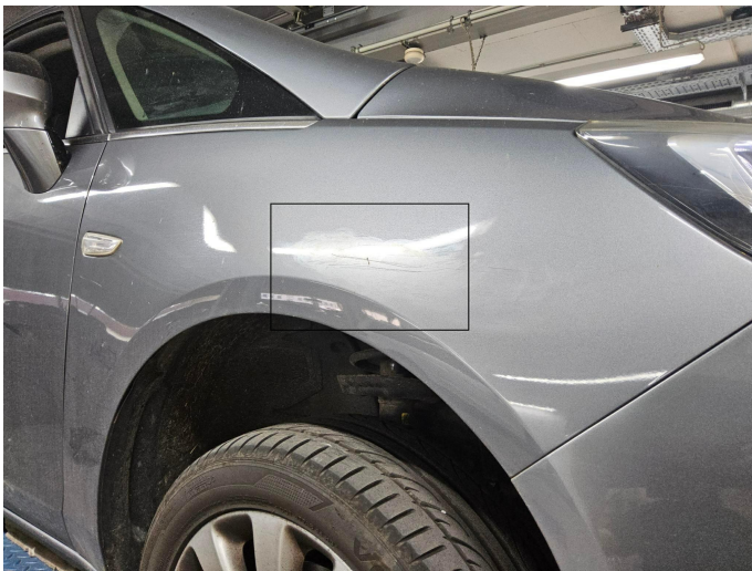
Bild 1: Außen, Kotflügel vorne rechts, deformiert, instandsetzen und lackieren mit Lackaufbau
