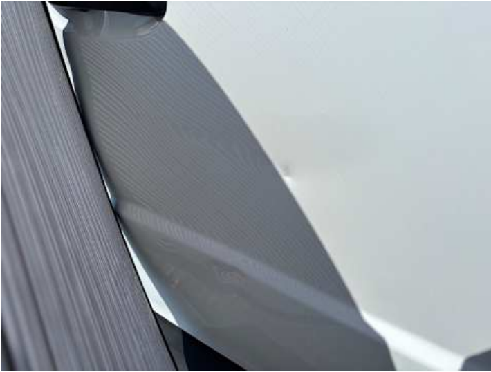
Heckklappe (Verformung, Delle, Lackschaden)
