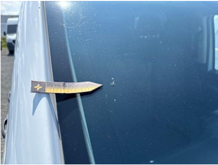
Windschutzscheibe (Steinschlag, Riss/Bruch)
