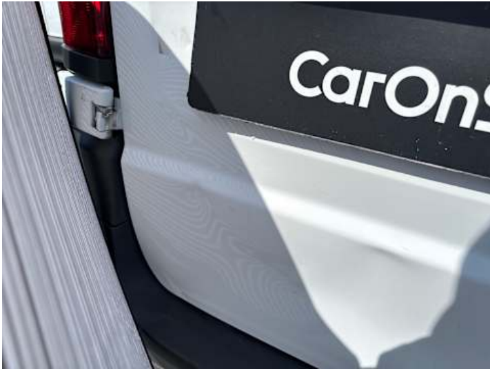
Heckklappe (Verformung, Delle, Lackschaden)
