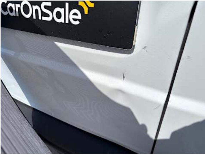
Heckklappe (Verformung, Delle, Lackschaden)
