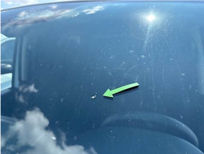
Windschutzscheibe (Steinschlag, Riss/Bruch)
