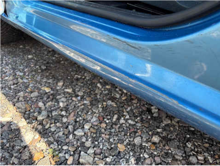
Schweller links (Verformung, Lackschaden)
