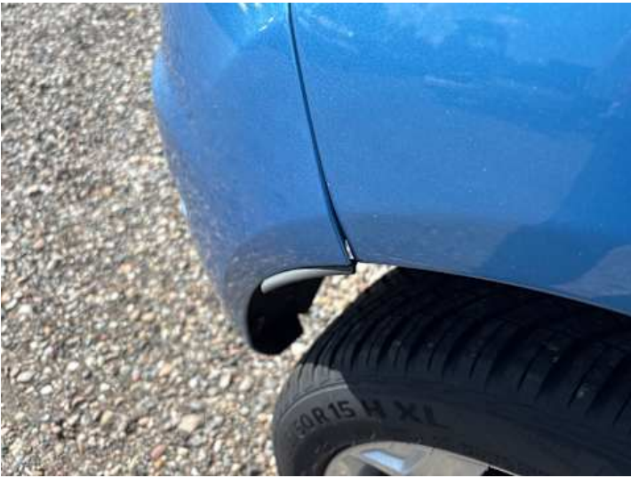
Stoßstange hinten (Spaltmaße ungenau, Kratzer, Lackschaden)
