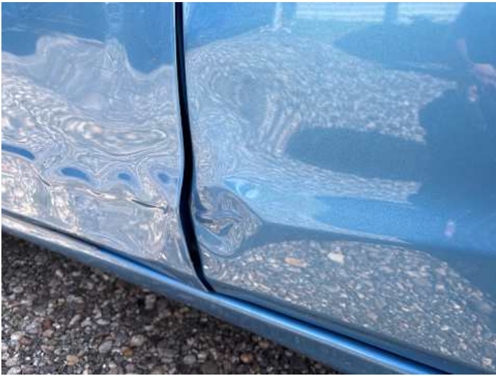
Türe hinten links (Verformung, Lackschaden)
