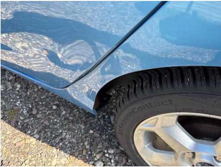
Seitenteil hinten links (Verformung, Spaltmaße ungenau)
