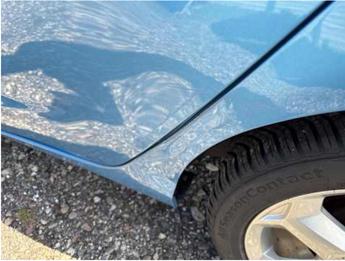
Türe hinten links (Verformung, Lackschaden)
