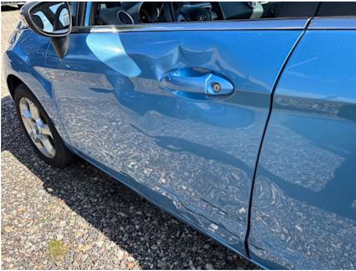
Fahrertür (Spaltmaße ungenau, Lackschaden, Verformung)
