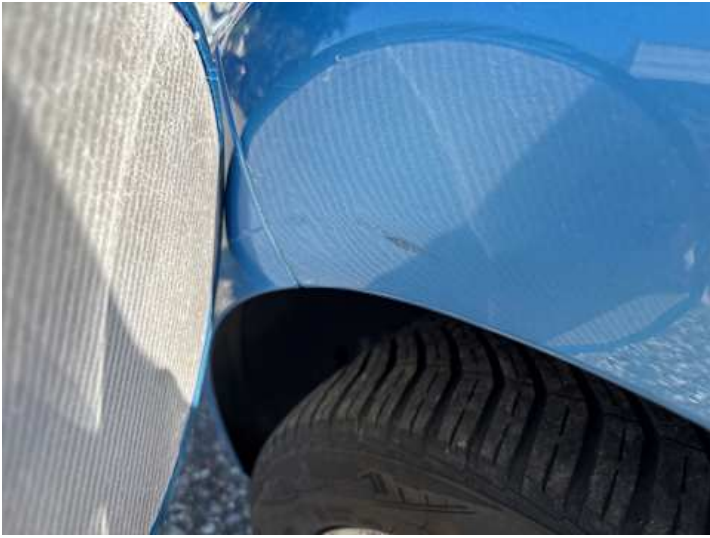
Kotflügel vorne links (Lackschaden, Kratzer, Delle)
