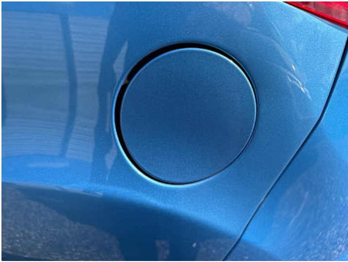
Seitenteil hinten links (Verformung, Spaltmaße ungenau)
