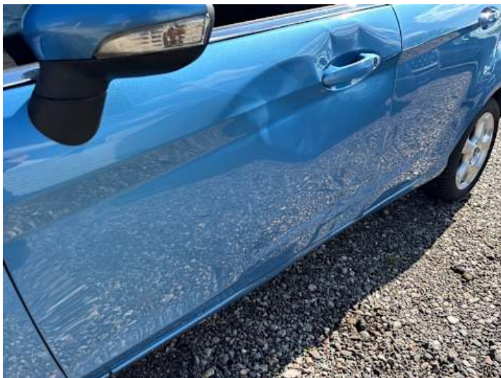
Fahrtür (Spaltmaße ungenau, Lackschaden, Verformung)
