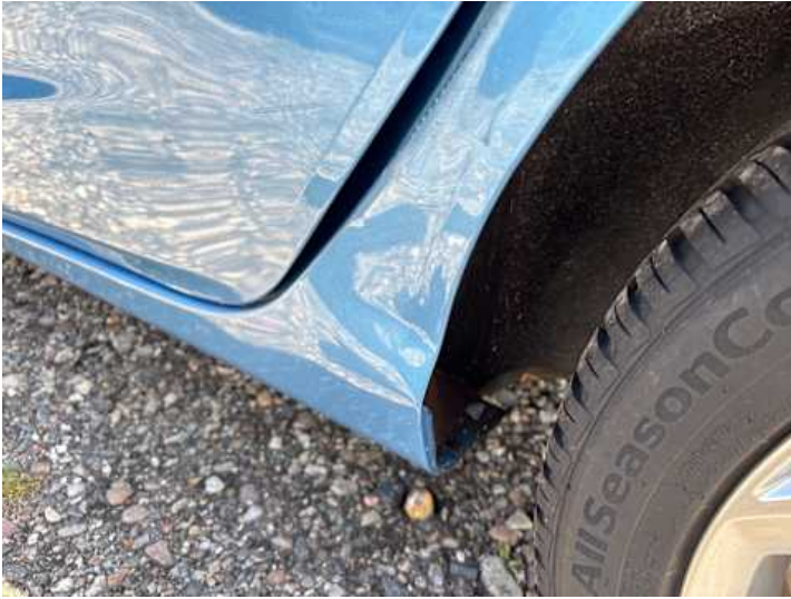
Schweller links (Verformung, Lackschaden)
