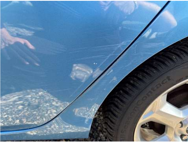
Türe hinten links (Verformung, Lackschaden)
