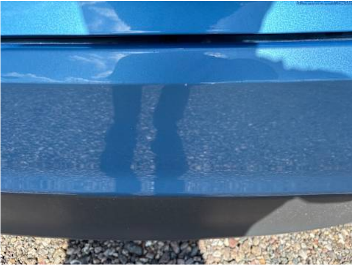
Stoßstange hinten (Spaltmaße ungenau, Kratzer, Lackschaden)
