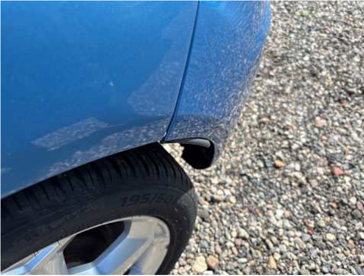
Stoßstange hinten (Spaltmaße ungenau, Kratzer, Lackschaden)
