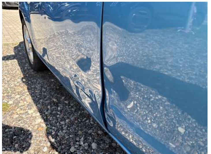
Fahrtür (Spaltmaße ungenau, Lackschaden, Verformung)
