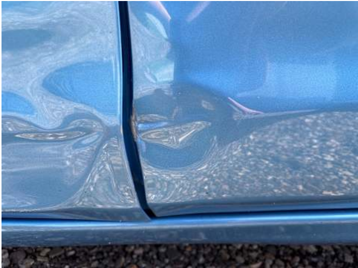
Türe hinten links (Verformung, Lackschaden)
