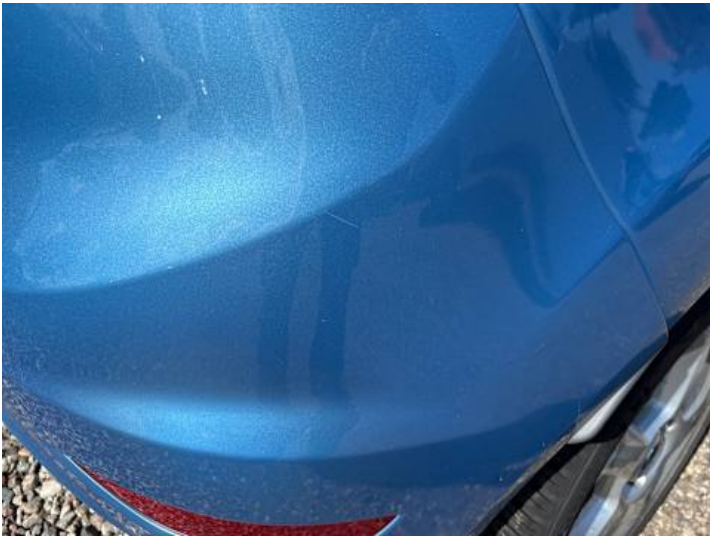
Stoßstange hinten (Spaltmaße ungenau, Kratzer, Lackschaden)
