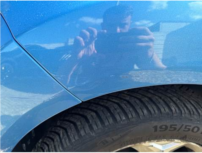
Kotflügel vorne links (Lackschaden, Kratzer, Delle)
