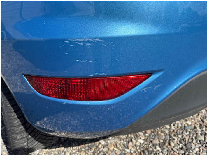
Stoßstange hinten (Spaltmaße ungenau, Kratzer, Lackschaden)
