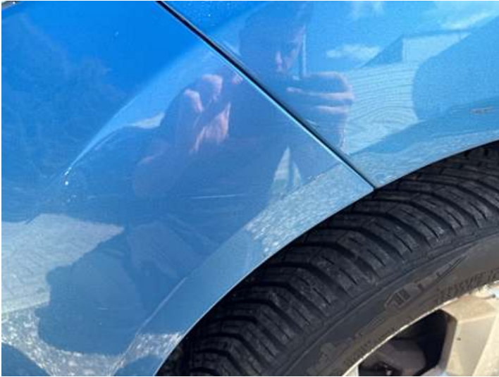
Stoßstange vorne (Lackschaden, Kratzer)
