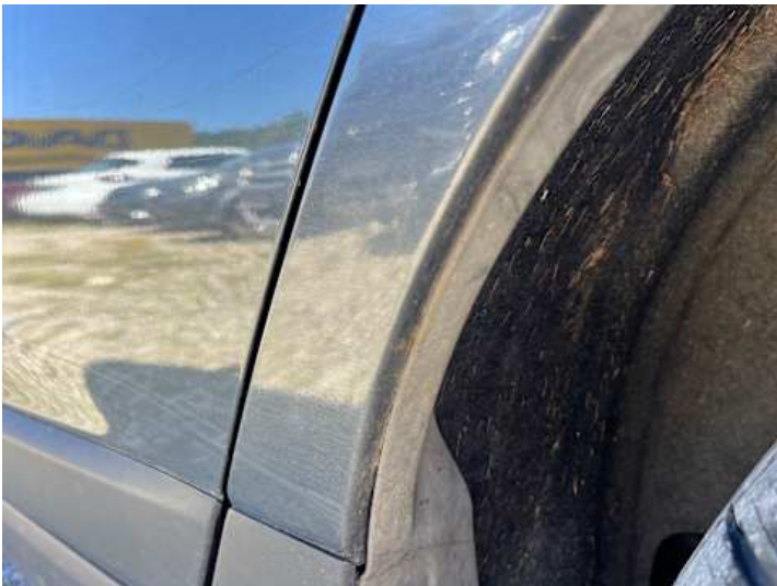
Seitenteil hinten links (Lackschaden, Rost)
