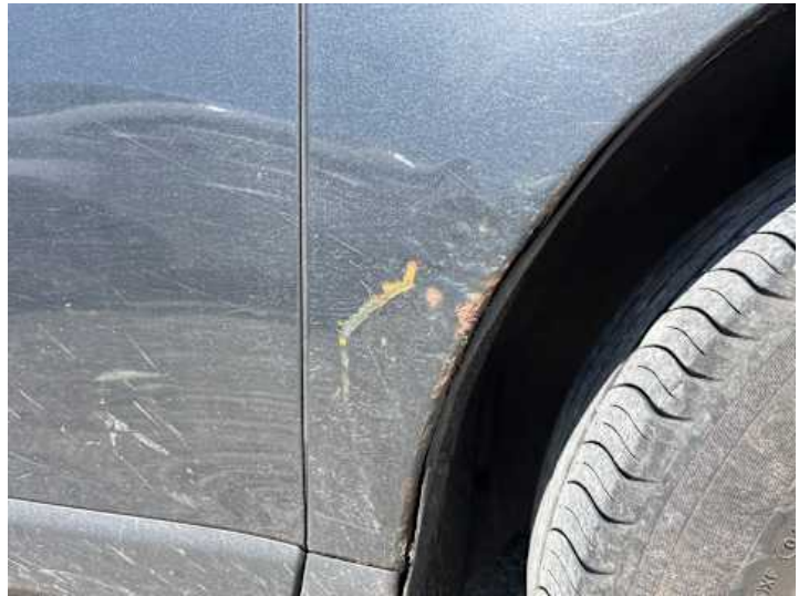
Kotflügel vorne rechts (Lackschaden, Rost)
