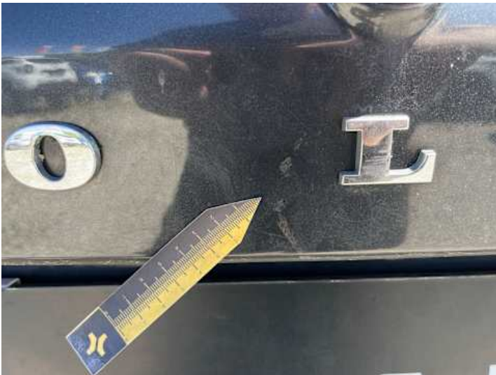
Heckklappe (Kratzer, Lackschaden, Unsachgemäß instand gesetzt)
