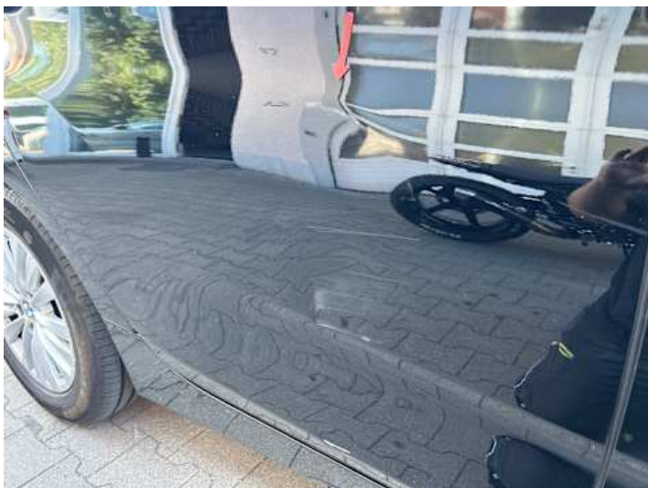
Türe hinten rechts (Delle, Kratzer)
