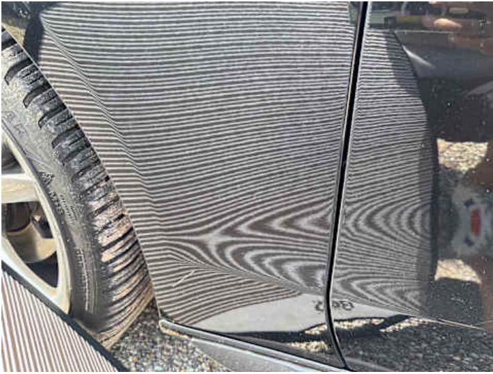
Kotflügel vorne links (Unsachgemäß instand gesetzt)
