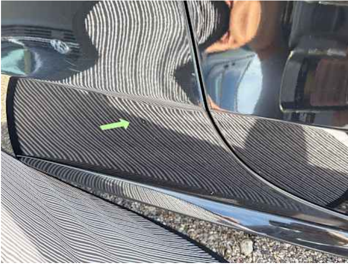
Seitenteil hinten rechts (Kratzer, Delle)
