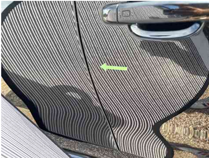
Beifahrtür (Verformung, Kratzer)
