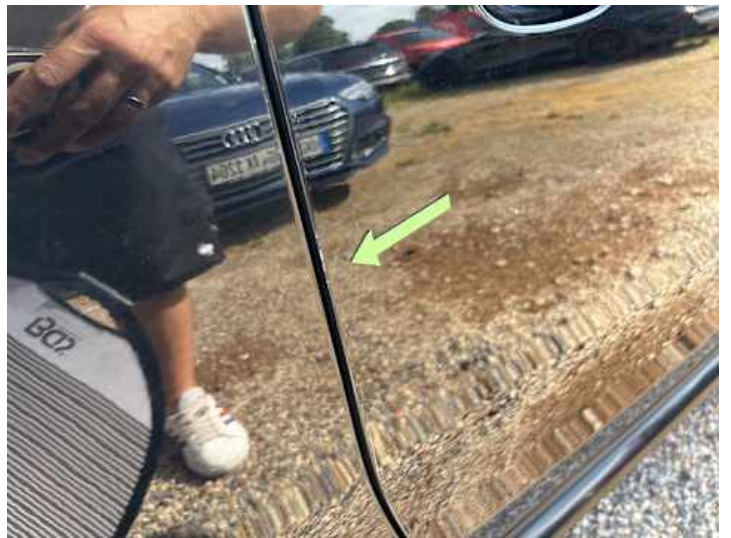
Beifahrtür (Verformung, Kratzer)
