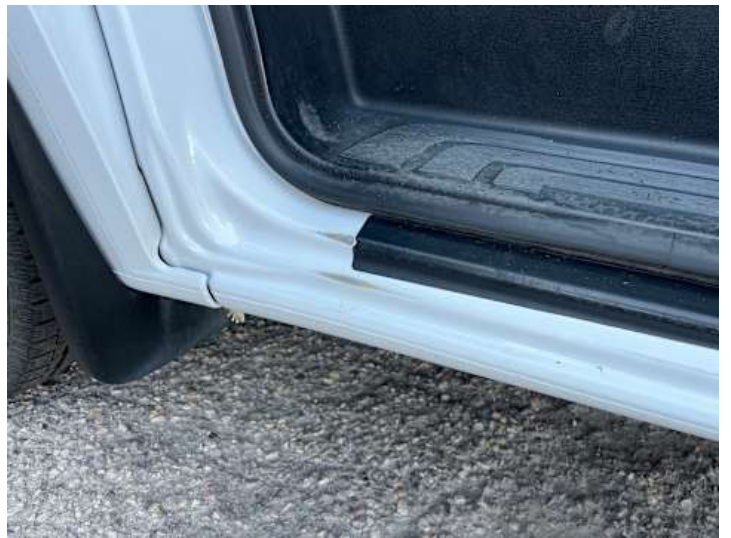
Schweller links (Lackschaden)
