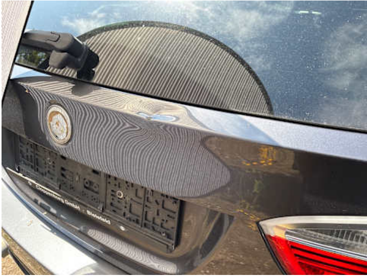
Heckklappe (Verformung, Delle)
