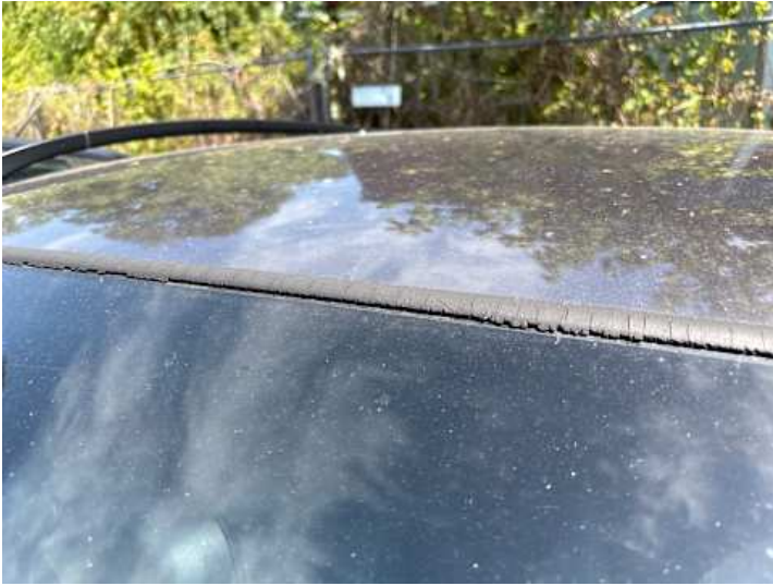
Windschutzscheibe (Anderer Schaden): Dichtung ist porös
