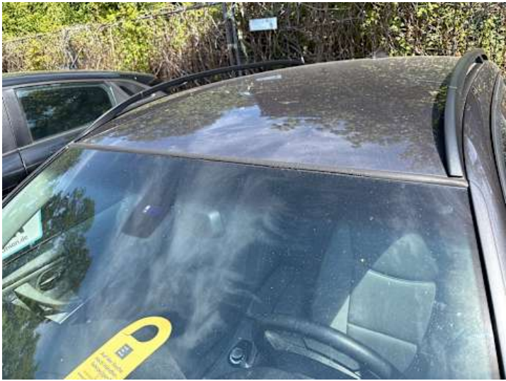
Windschutzscheibe (Anderer Schaden): Dichtung ist porös
