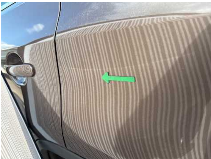
Seitenteil hinten links (Delle, Kratzer)
