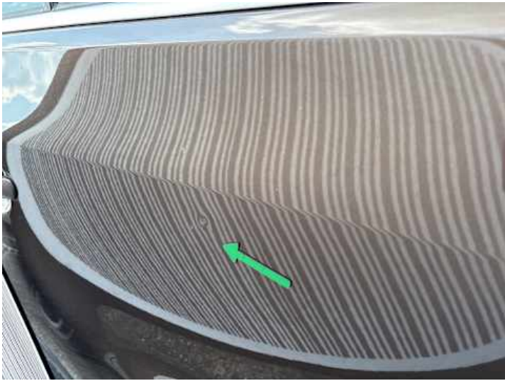
Türe hinten rechts (Delle, Kratzer)
