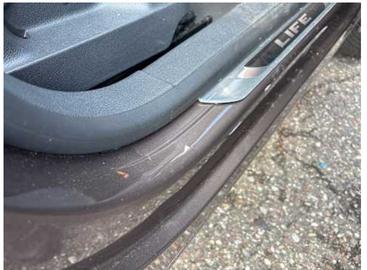
Schweller rechts (Delle, Kratzer)
