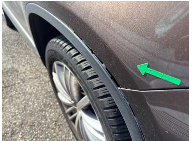
Kotflügel vorne rechts (Spaltmaße ungenau)
