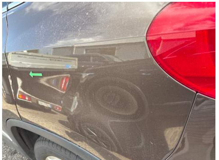
Seitenteil hinten links (Delle, Kratzer)
