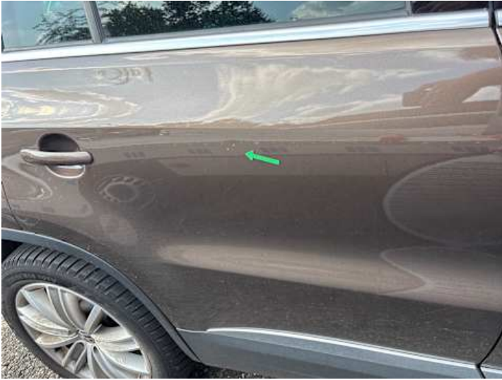
Türe hinten rechts (Delle, Kratzer)
