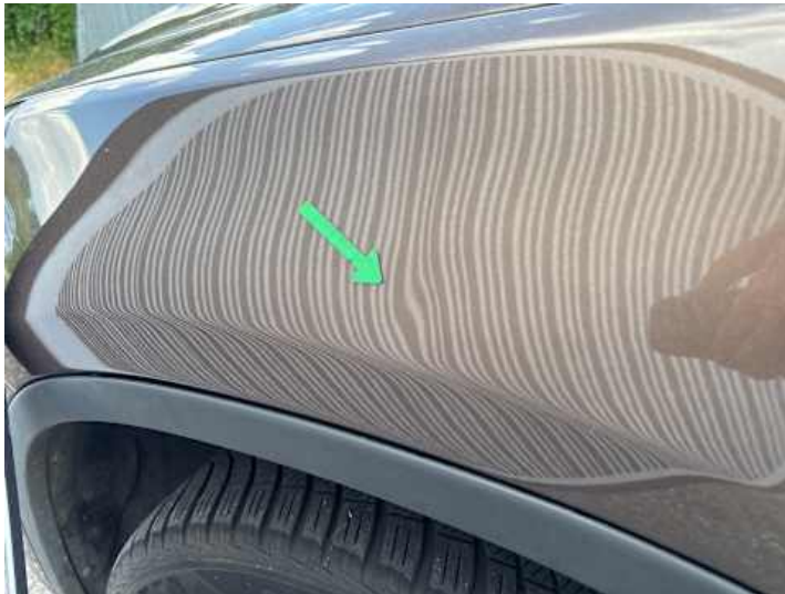
Kotflügel vorne links (Delle)
