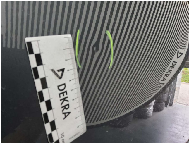
Seitenwand (lang) hinten links, vorne, mehrfach eingedellt, drücken (DEKRA)
