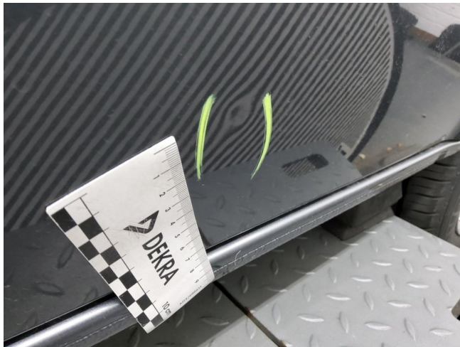
Tür vorne rechts, eingedellt, drücken (DEKRA)
