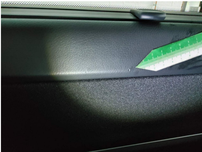
Schiebetürverkleidung verschrammt, Minderwert (DEKRA)
