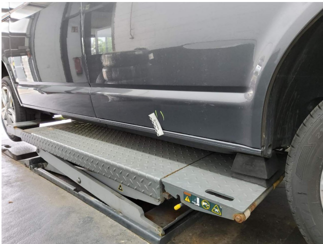
Tür vorne rechts, eingedellt, drücken (DEKRA)
