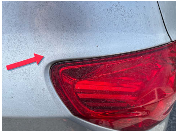
Seitenteil hinten links (Kratzer)
