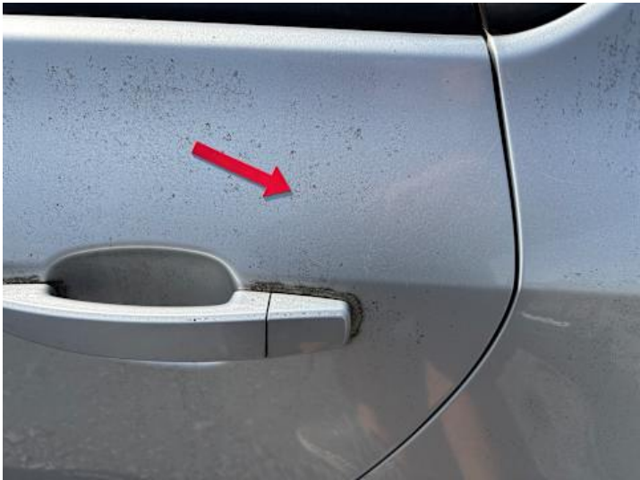
Türe hinten links (Kratzer)
