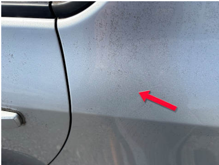
Seitenteil hinten links (Kratzer)
