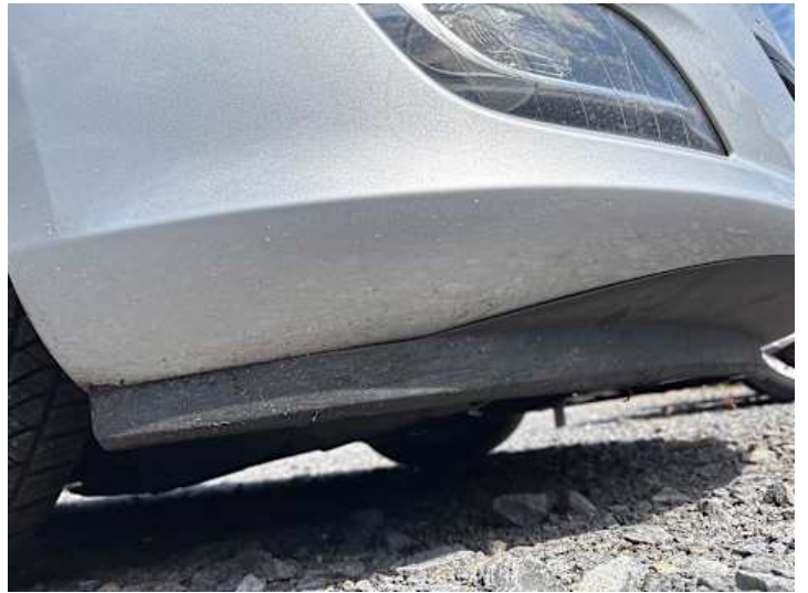
Stoßstange vorne (Kratzer, Spaltmaße ungenau)
