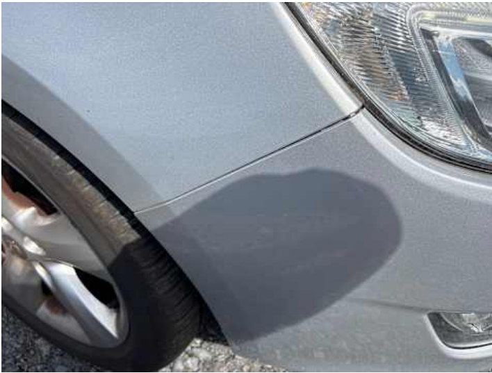
Stoßstange vorne (Kratzer, Spaltmaße ungenau)
