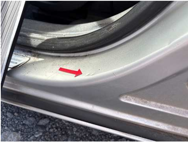
Fahrtür (Delle, Kratzer)
