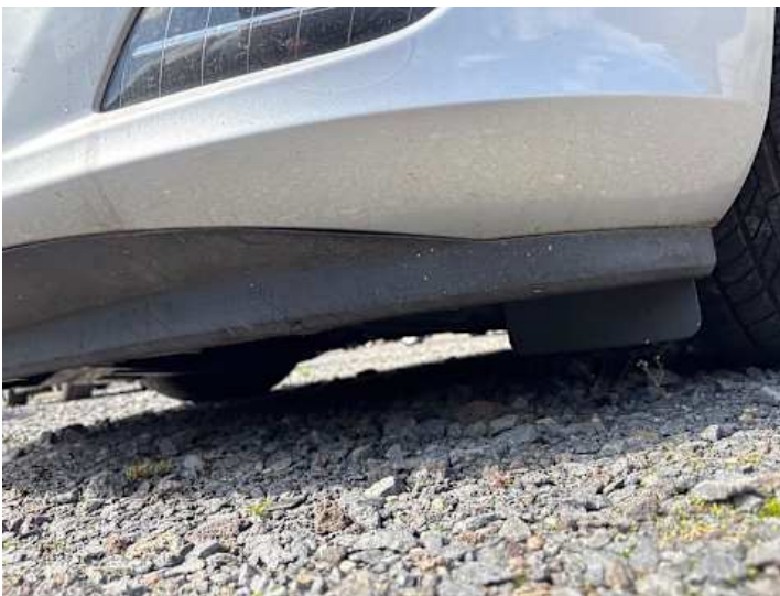
Stoßstange vorne (Kratzer, Spaltmaße ungenau)
