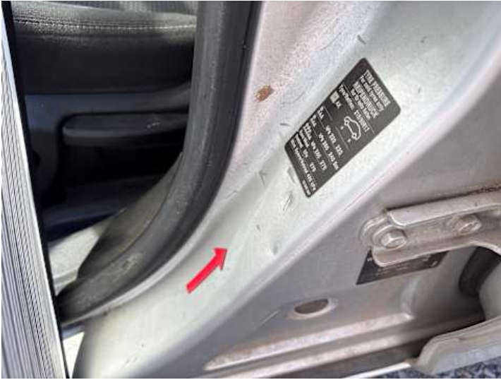
Fahrtür (Delle, Kratzer)
