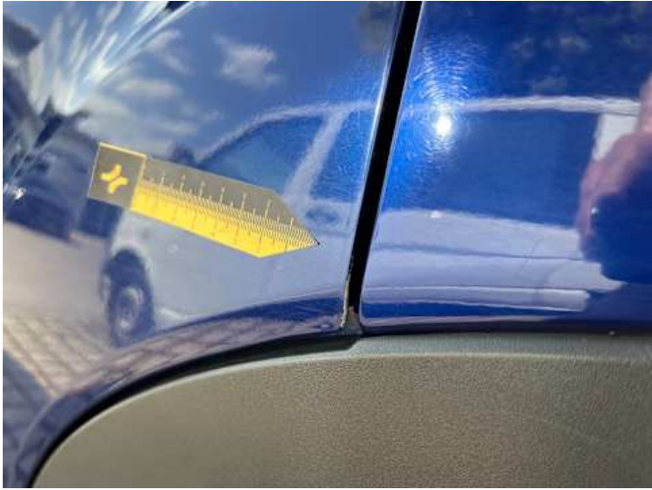
Türe hinten links (Lackschaden)
