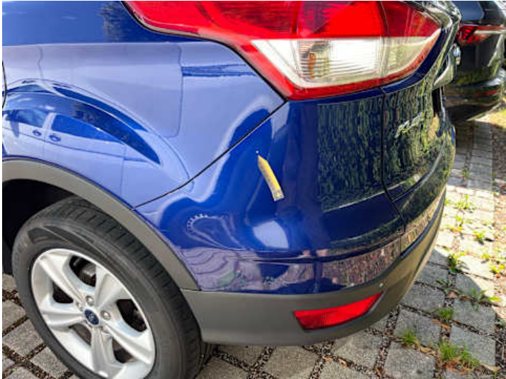
Stoßstange hinten (Lackschaden)
