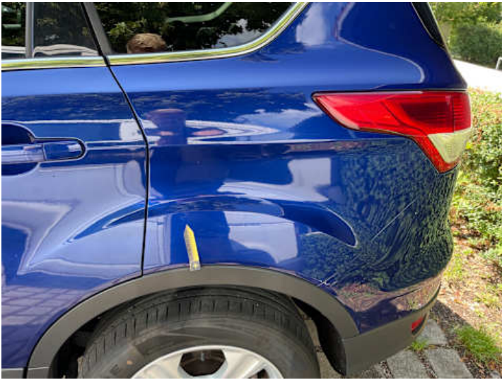
Seitenteil hinten links (Lackschaden, Unsachgemäß instand gesetzt)
