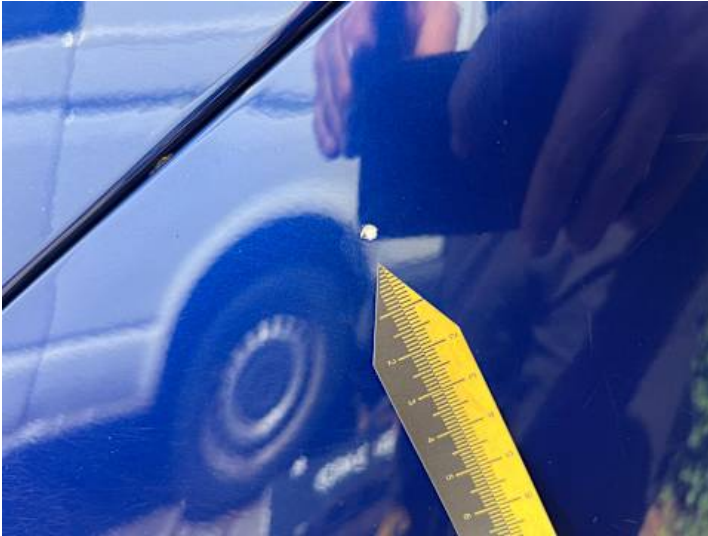
Stoßstange hinten (Lackschaden)
