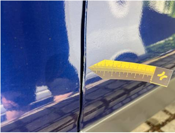
Türe hinten links (Lackschaden)
