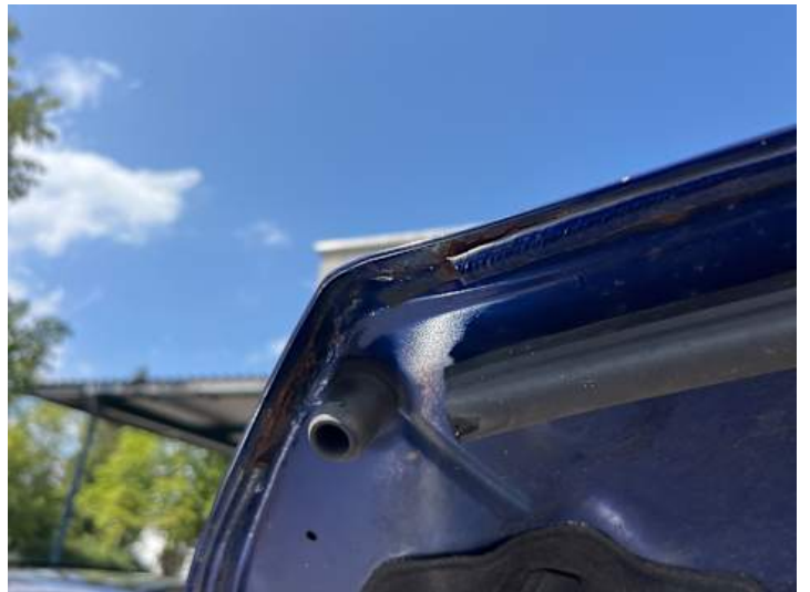
Motorhaube (Lackschaden, Rost)
