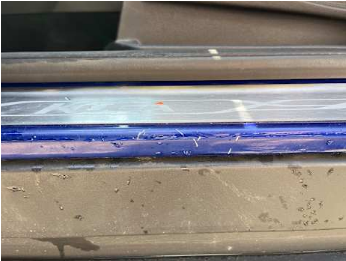
Schweller links (Kratzer, Lackschaden)
