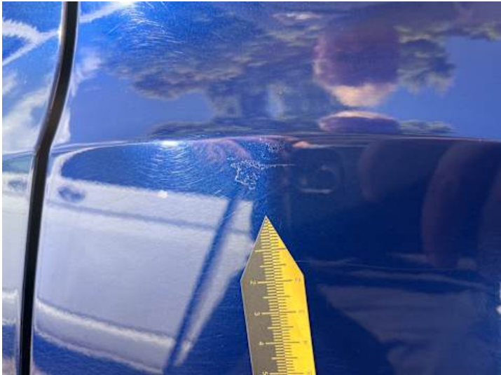
Seitenteil hinten links (Lackschaden, Unsachgemäß instand gesetzt)
