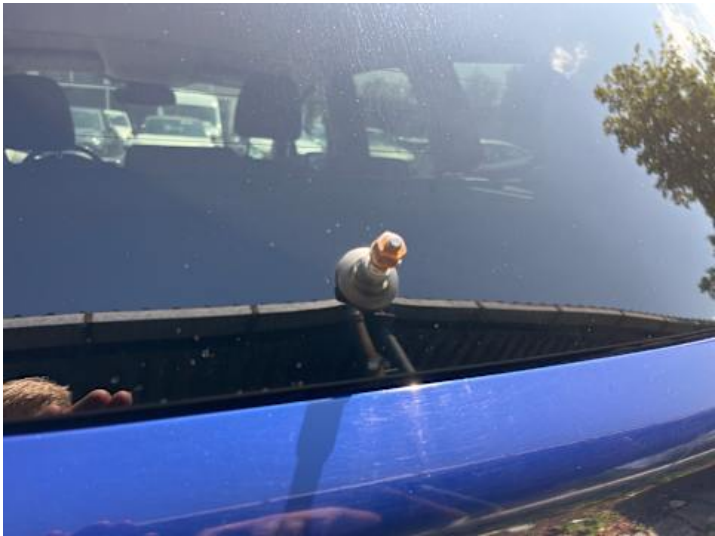
Rückscheibe (Anderer Schaden): Heckscheibenwischer fehlt;
