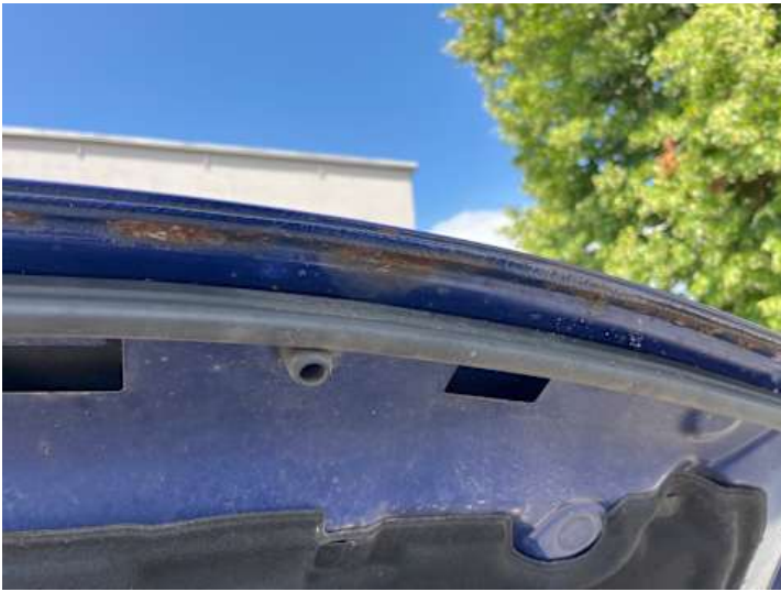
Motorhaube (Lackschaden, Rost)
