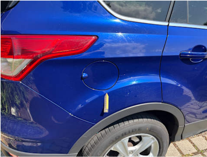
Seitenteil hinten rechts (Kratzer, Lackschaden)
