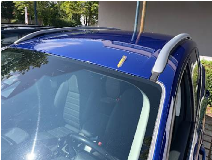
Dach (Lackschaden, Steinschlag)
