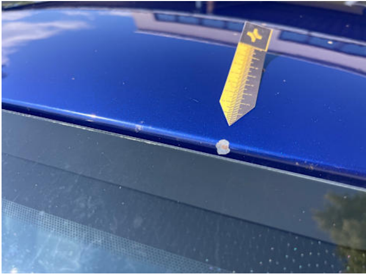
Dach (Lackschaden, Steinschlag)
