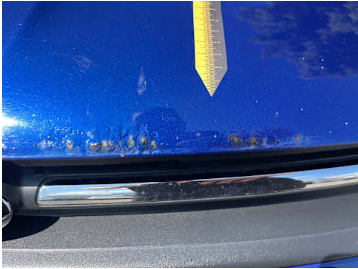
Motorhaube (Lackschaden, Rost)
