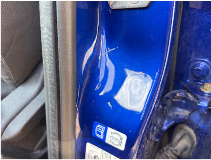
Fahrertür (Kratzer, Lackschaden)
