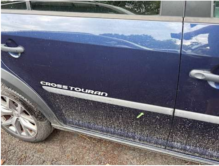
Türe hinten rechts (Delle)
