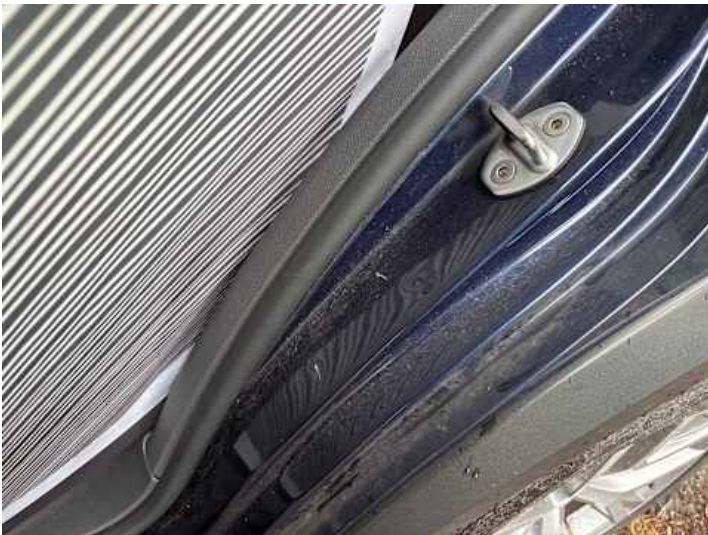
Schweller links (Kratzer, Lackschaden, Delle)
