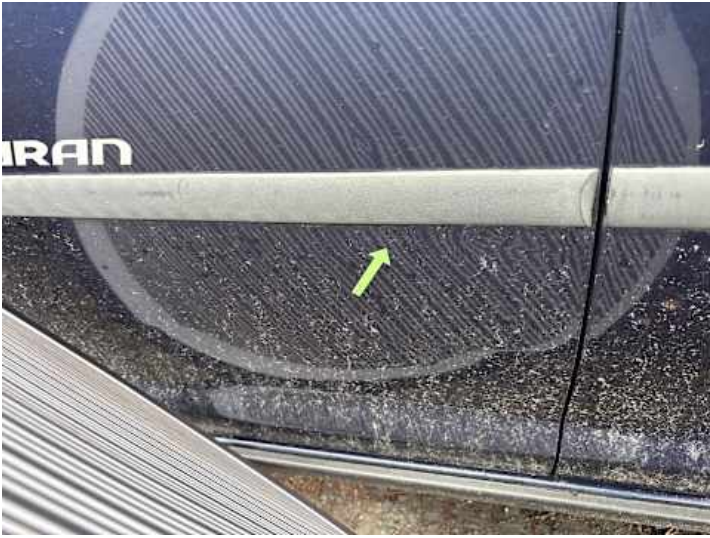
Türe hinten rechts (Delle)
