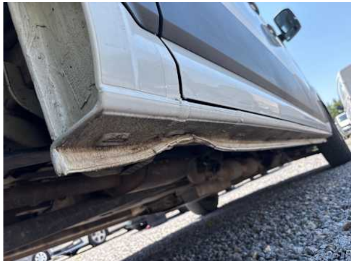
Schweller rechts (Verformung)
