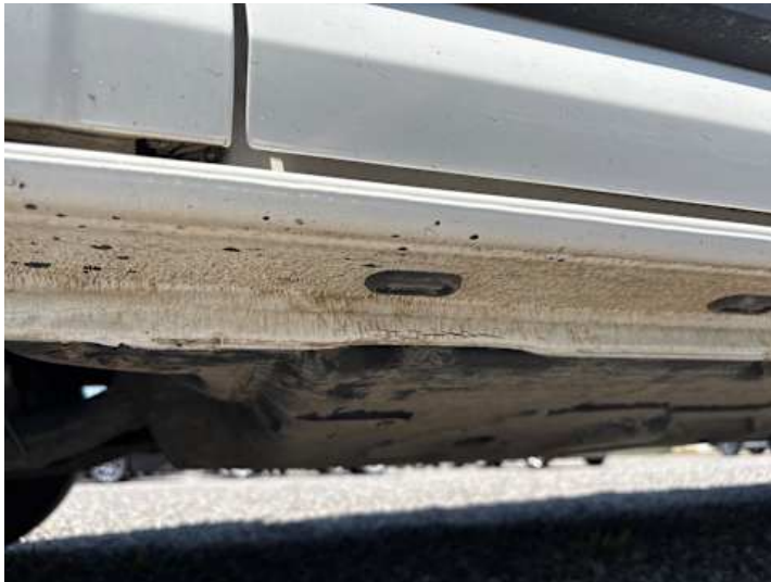
Schweller links (Verformung)
