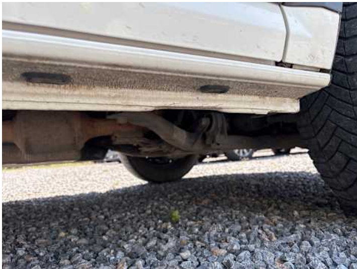
Schweller rechts (Verformung)
