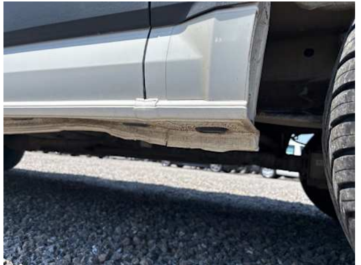
Schweller links (Verformung)
