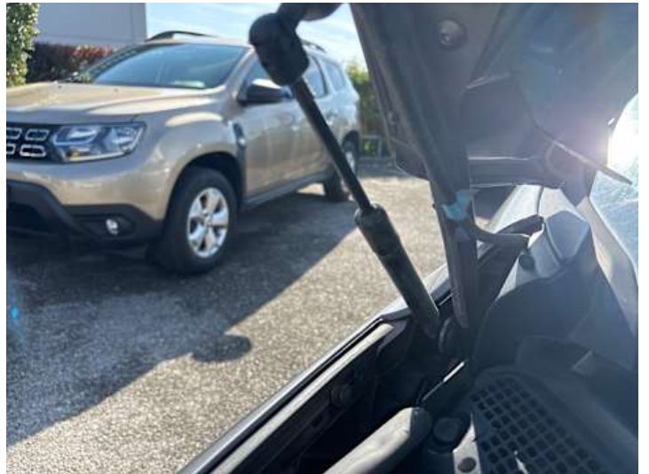
Motorhaube (Anderer Schaden): Dämpfer defekt
