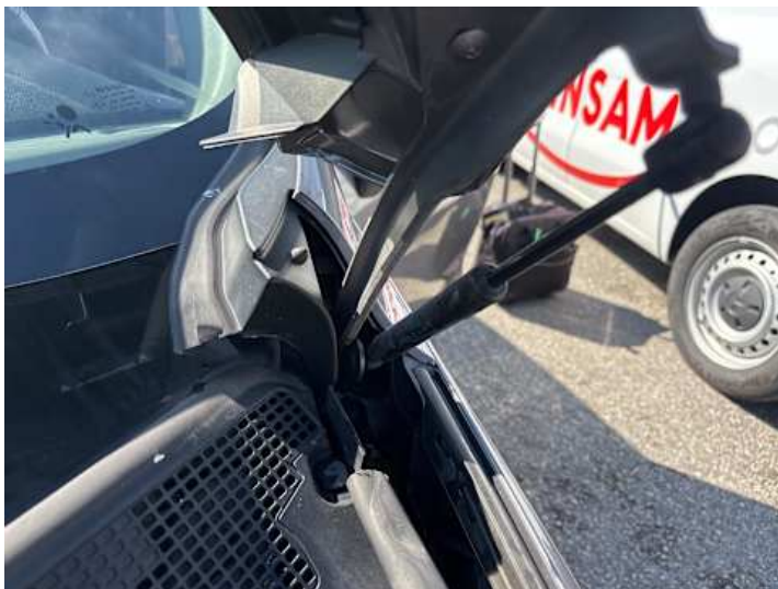
Motorhaube (Anderer Schaden): Dämpfer defekt
