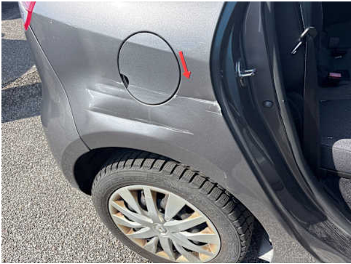
Seitenteil hinten rechts (Verformung, Kratzer, Lackschaden)
