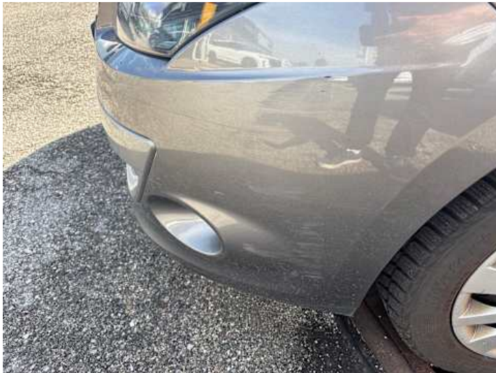
Stoßstange vorne (Kratzer, Lackschaden)
