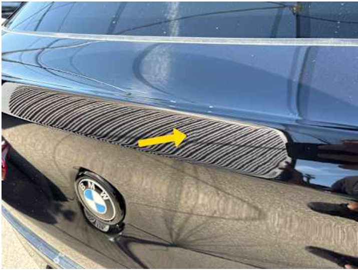
Heckklappe (Delle, Kratzer)
