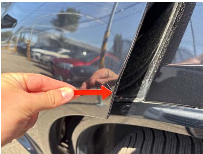
Türe hinten links (Lackschaden)
