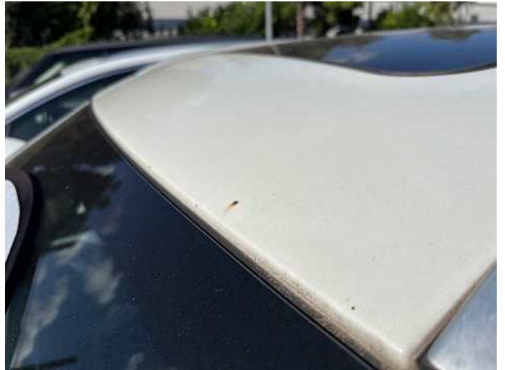
Dach (Steinschlag, Rost)
