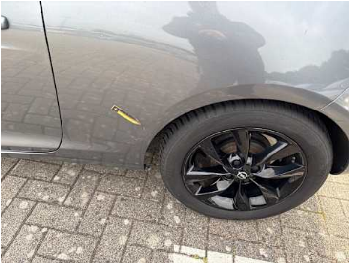
Seitenteil hinten links (Delle, Lackschaden)
