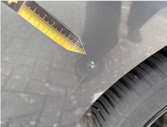
Seitenteil hinten links (Delle, Lackschaden)
