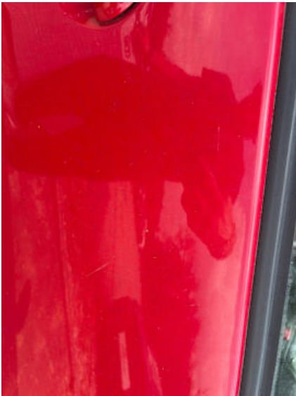
Beifahrertür (Lackschaden, Kratzer)
