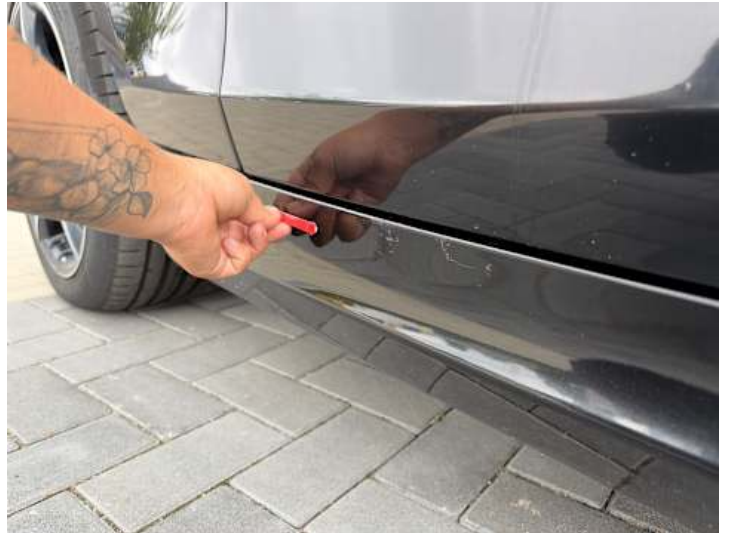
Schweller links (Lackschaden)
