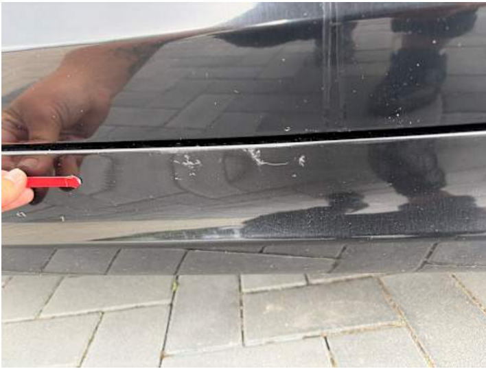
Schweller links (Lackschaden)
