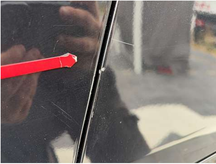
Seitenteil hinten links (Lackschaden)
