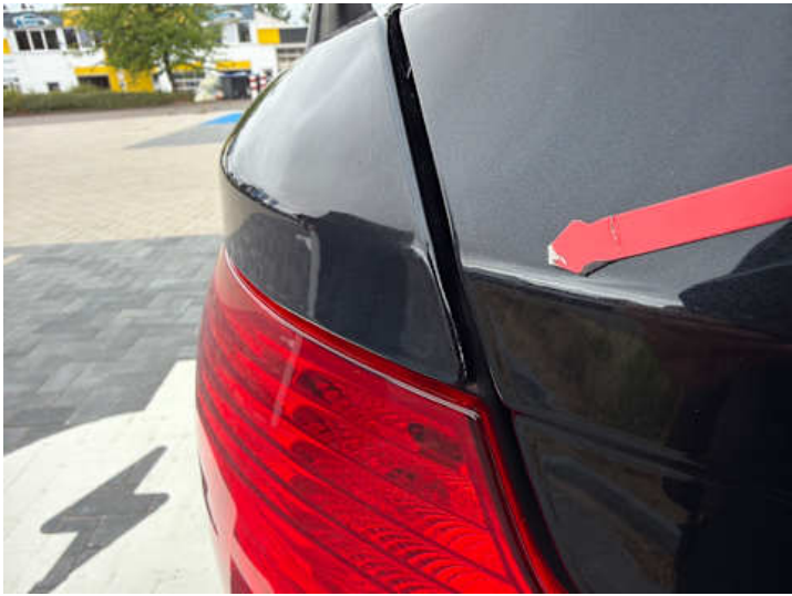
Seitenteil hinten links (Lackschaden)
