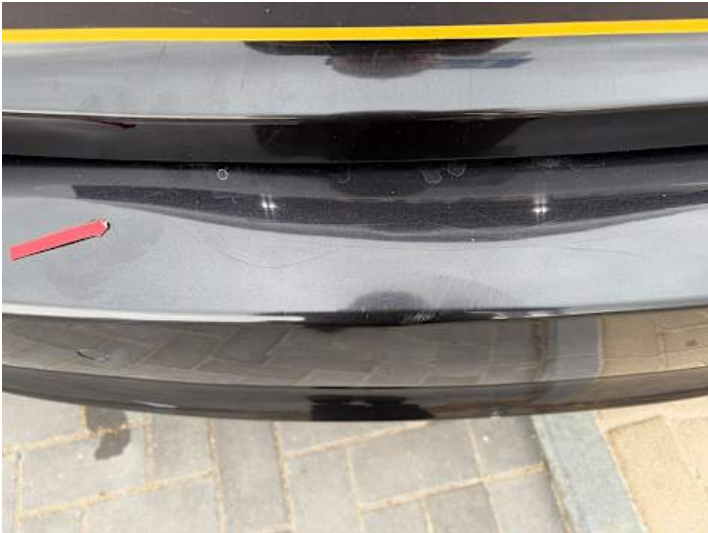
Stoßstange hinten (Riss/Bruch)
