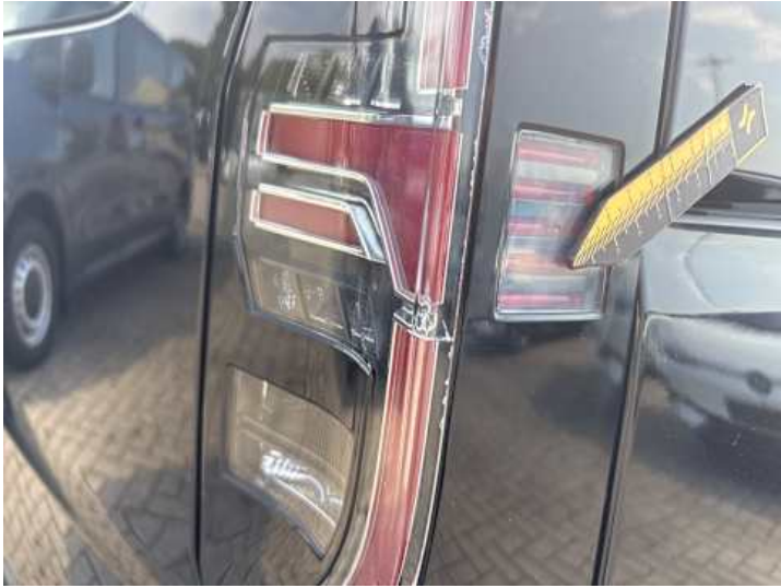
Rücklicht (rechts) (Riss/Bruch)
