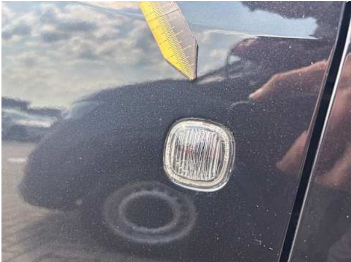
Kotflügel vorne links (Riss/Bruch)
