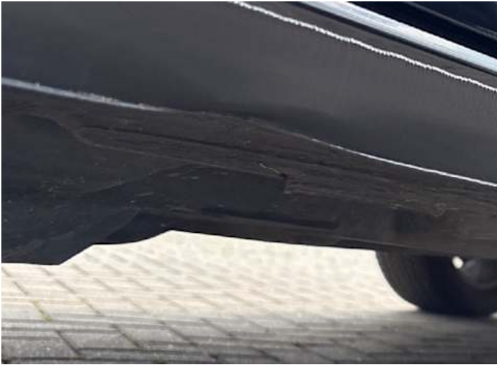
Schweller rechts (Verformung)
