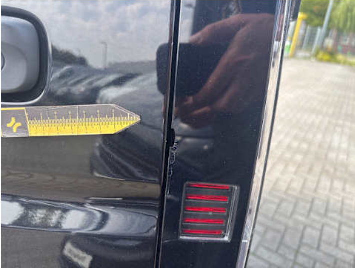
Rücklicht (links) (Riss/Bruch)
