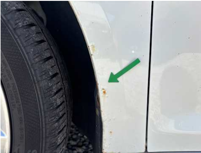
Kotflügel vorne links (Rost)
