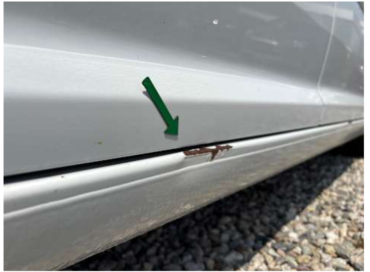
Schweller rechts (Rost, Lackschaden)
