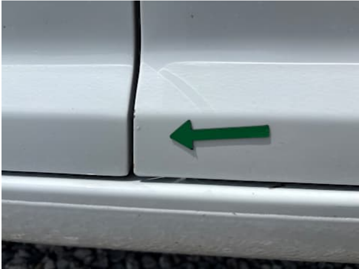
Türe hinten rechts (Rost)
