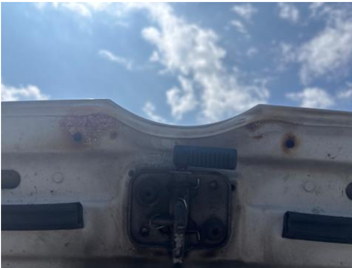
Motorhaube (Rost, Verformung)
