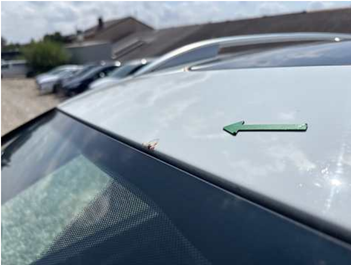
Dach (Steinschlag, Lackschaden, Rost)
