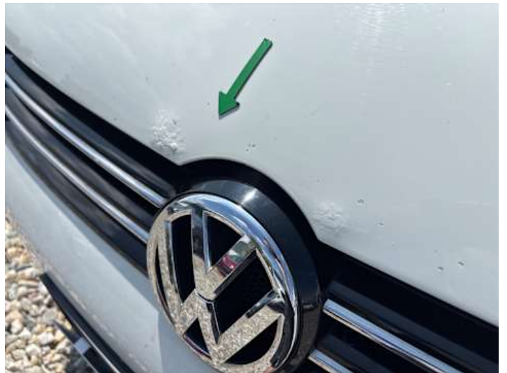
Motorhaube (Rost, Verformung)
