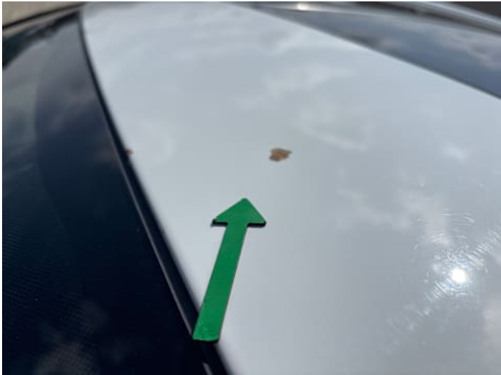
Dach (Steinschlag, Lackschaden, Rost)
