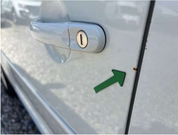
Fahrtür (Kratzer, Rost)
