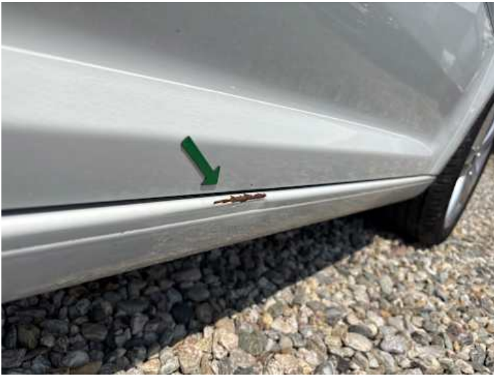
Schweller rechts (Rost, Lackschaden)
