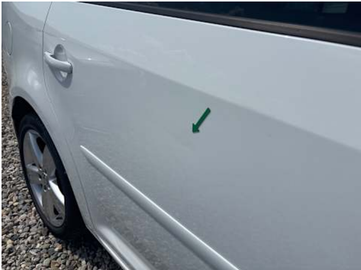
Türe hinten rechts (Verformung)
