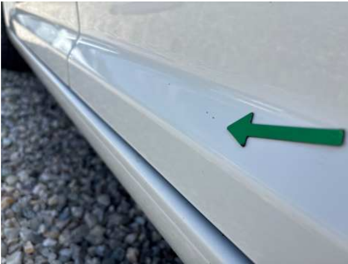
Türe hinten links (Rost)
