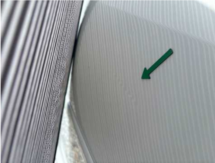
Türe hinten rechts (Verformung)
