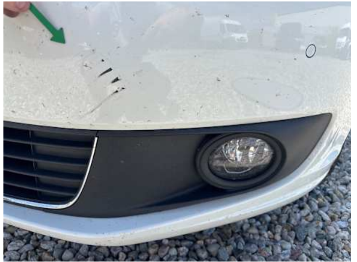
Stoßstange vorne (Kratzer, Riss/Bruch)
