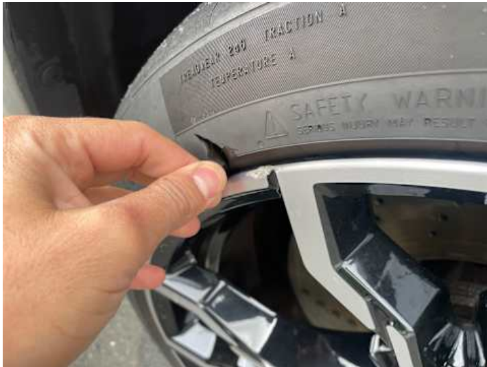
Rad (Kratzer, Riss/Bruch)
