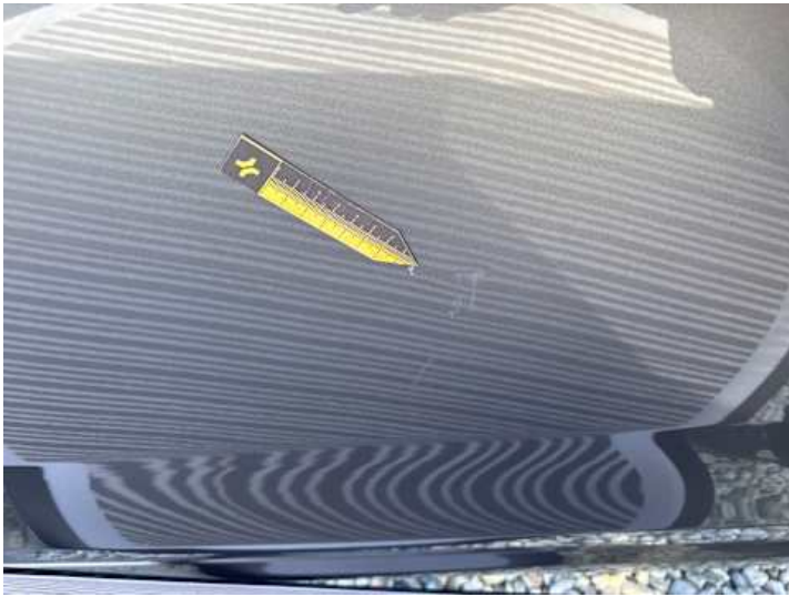
Fahrentür (Kratzer, Delle)
