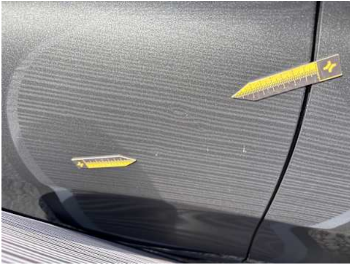
Türe hinten rechts (Kratzer, Delle)
