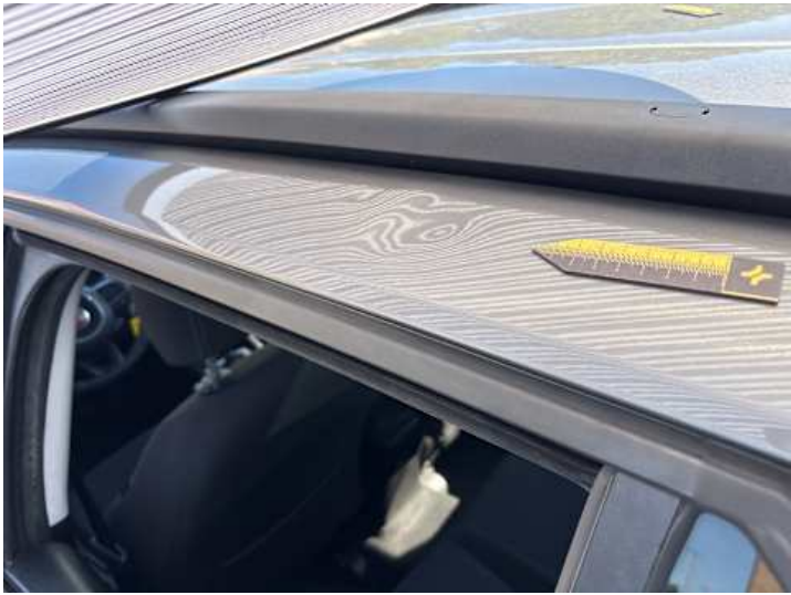
Dach (Delle, Verformung)
