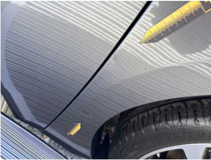
Seitenteil hinten links (Kratzer, Delle)
