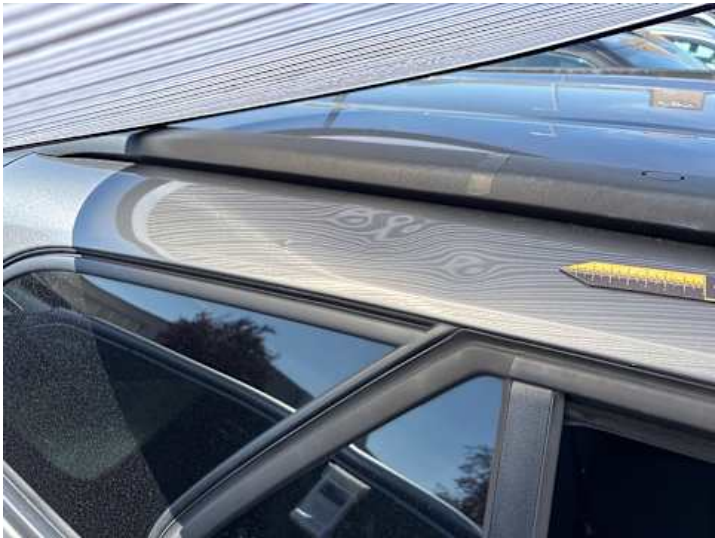
Dach (Delle, Verformung)
