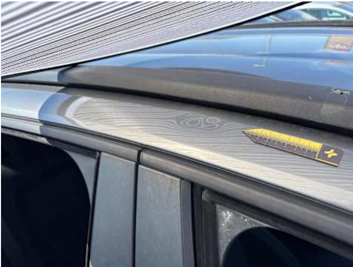
Dach (Delle, Verformung)
