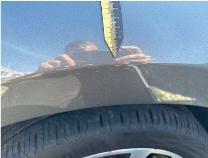
Kotflügel vorne links (Kratzer)
