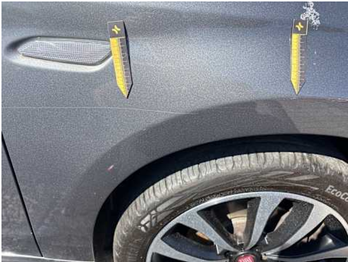
Kotflügel vorne rechts (Kratzer)
