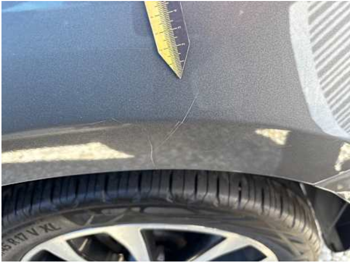
Seitenteil hinten links (Kratzer)
