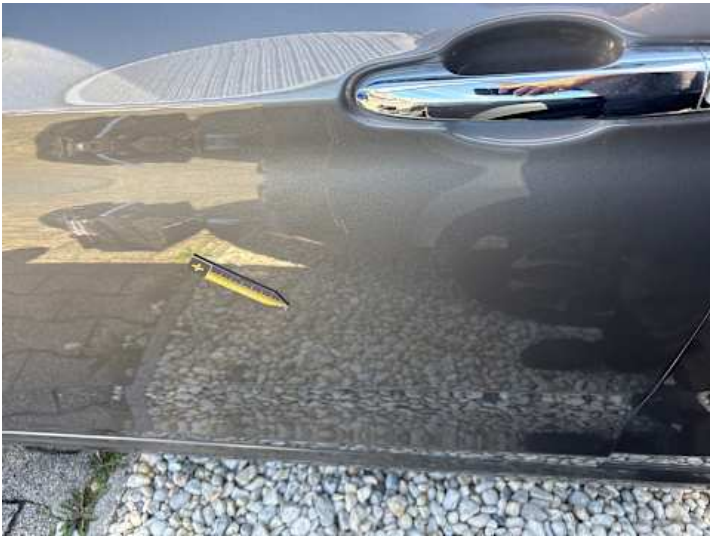
Fahrentür (Kratzer, Delle)
