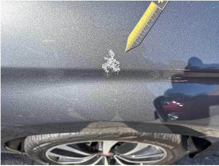
Kotflügel vorne rechts (Lackschaden)
