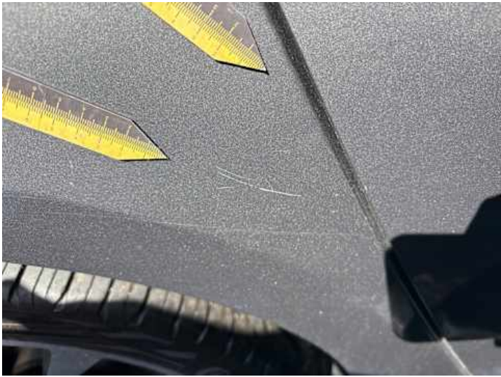
Seitenteil hinten rechts (Kratzer, Delle)
