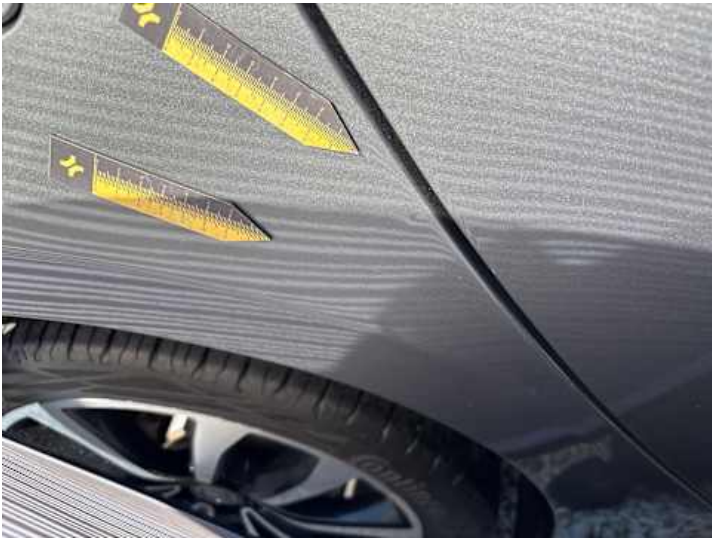
Seitenteil hinten rechts (Kratzer, Delle)
