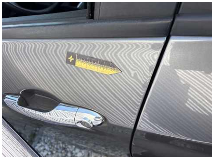
Fahrtür (Kratzer, Delle)
