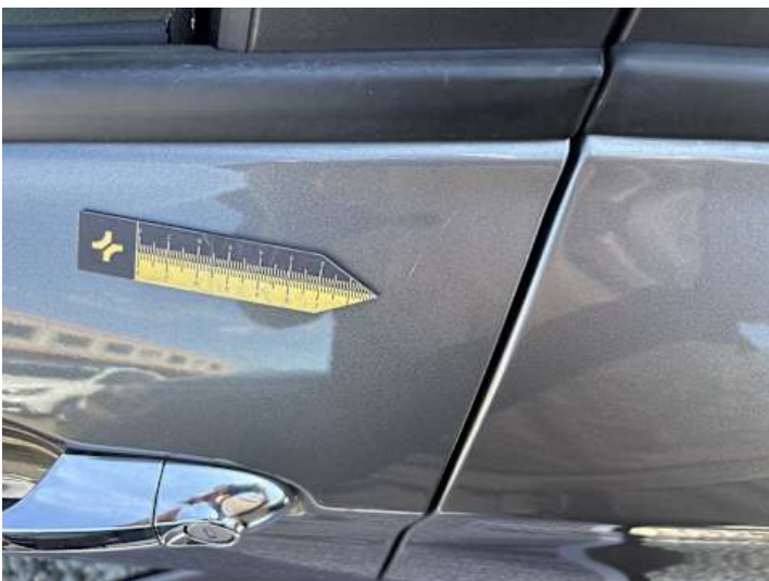
Fahrtür (Kratzer, Delle)
